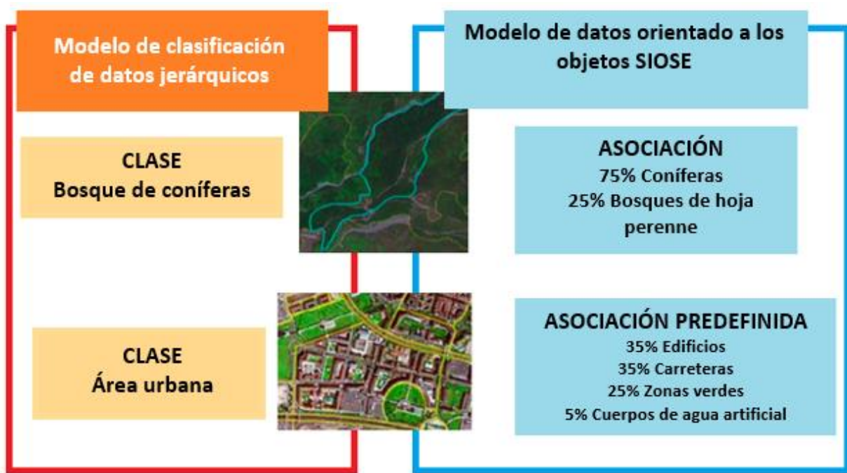
Figura 3.1.- Ejemplo de clasificación utilizando un sistema de modelación jerárquica de datos y el Sistema de Información de Ocupación (SIOSE)
