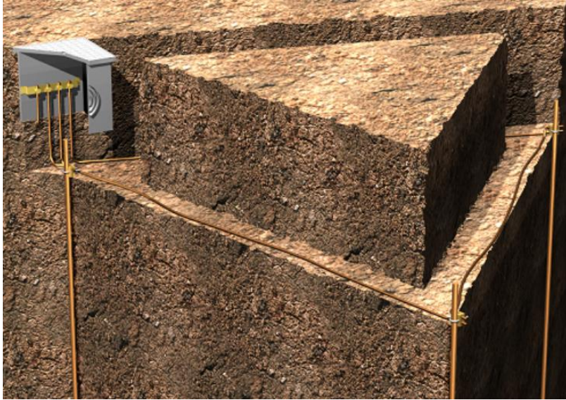
Figura 23: Detalle de una puesta a tierra mediante conductores y piquetas (Fuente: generadordeprecios.info)
