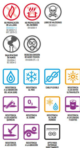
Figura 26: Características principales conductor Tecsun H1Z2Z2-K (Fuente: catálogo Tecsun)
