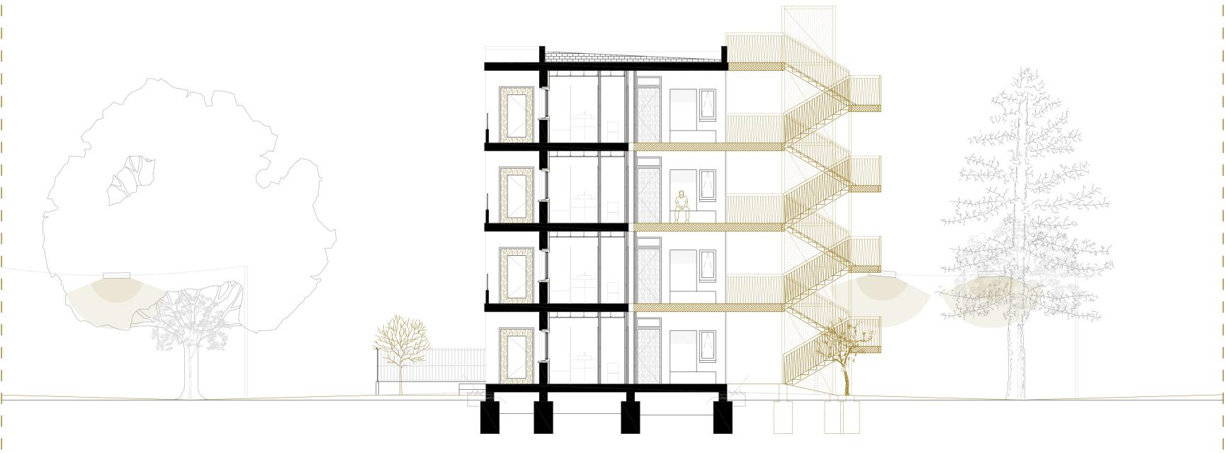
Los nuevos núcleos de comunicación y extensiones de terraza se construyen mediante tubulares estructurales de acero galvanizado debidamente soldados. Posteriormente se aplica una imprimación de refuerzo por la pérdida de galvanizado y finalmente se aplica un lacado en color bronce. Las nuevas estructuras se anclan a los forjados con placas atornilladas a ambos elementos.
