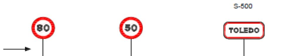
FIGURA 48: TIPO DE SEÑALIZACIÓN PARA PRINCIPIOS DE TRAVESÍA
