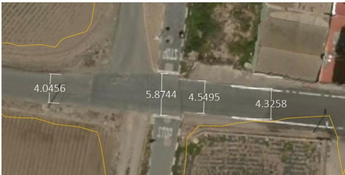
**FIGURA 24: SECCIÓN TRANSVERSAL PARA EL P.K.0+300.00**
