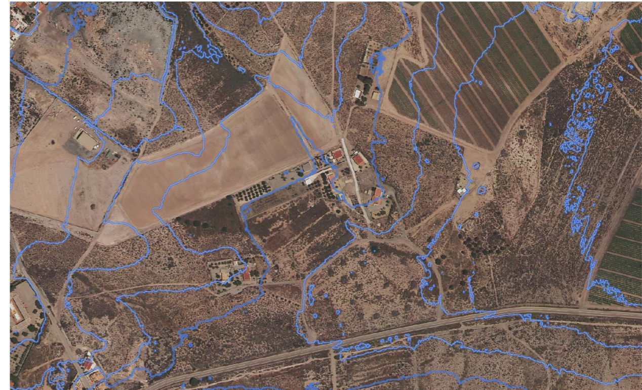
Figura 1: Superficie creada con líneas de nivel (Rango 1 m-5 m) sobre ortofoto. (Fuente: Elaboración propia)
