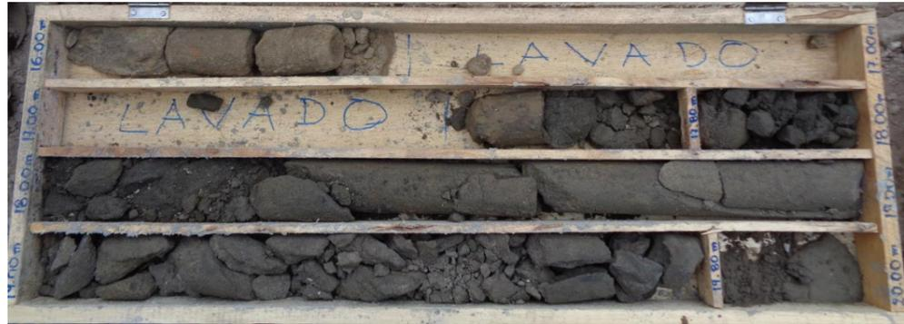
Figura 21. Tobs arenosas procedentes de la campaña de reconocimiento. Sondeo PTB-04, tramo 16.00 a 20.00m. Coordenadas: 758632E;9950473N.
