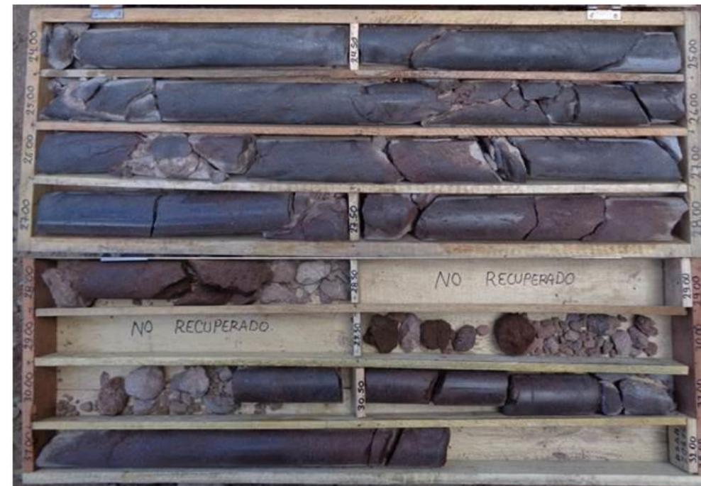
**Figura 28. Vista de la zona de cizallamiento procedente de la campaña de reconocimiento. Sondeo PTB-1, tramo 24.00-32.00m.**
