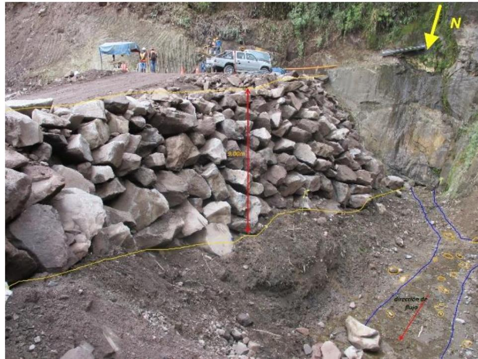
Figura 33. Depósito aluvial, bajo materiales antrópicos (757807E; 9949975N).
