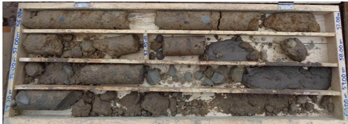
Figura 14. Vista de la brecha tobácea marrón rojiza, procedente de la campaña de reconocimiento. Portal de salida. Sondeo PTB-04, tramo 56.00 – 60.00m. Coordenadas: 758632E, 9950473N.
