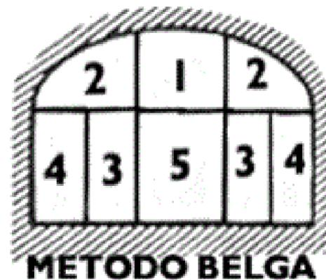
Figura 10. Proceso constructivo del método belga. Fuente: civilgeeks.
