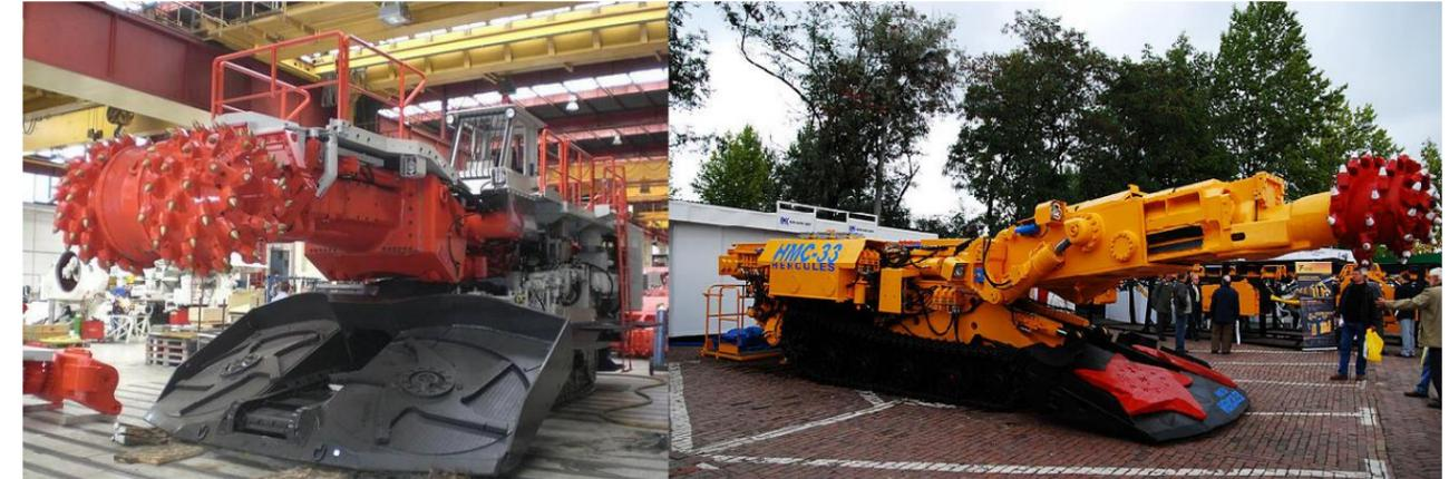
Figura 16. Rozadoras tipo *milling* (izquierda) y *ripping* (derecha).
