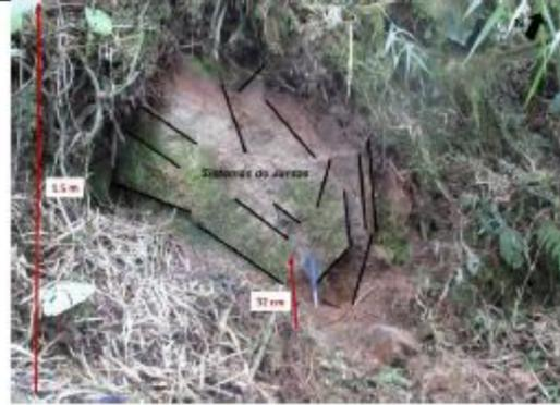
PIE DE FOTO: Afloramiento de andesita piroxénica altamente meteorizada y fracturada
