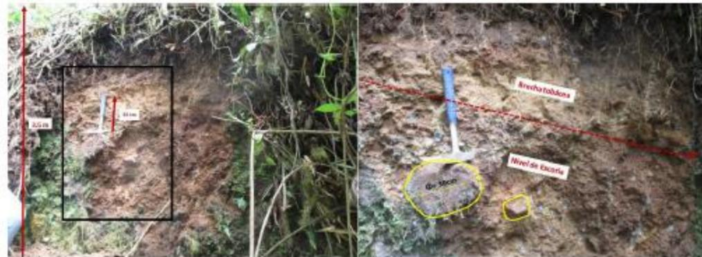
PIE DE FOTO: Afloramiento con un nivel superior de brecha tobácea y un nivel inferior de escoria.
