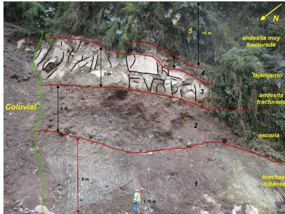
Figura 22. Brechas tobáceas bajo lavas. Portal de entrada del túnel. (757825E;9950021N). Vermuestra RPE-01.
