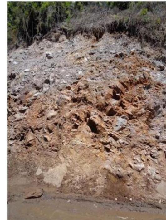
Figura 24. Aglomerados volcánicos. Portal de salida del túnel Bombolí. Coordenadas: 759118E; 9950964N
