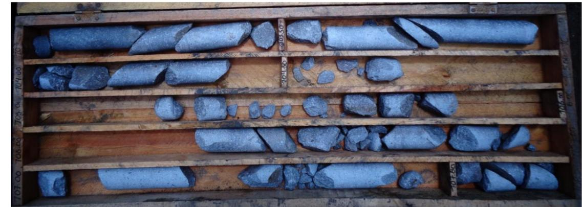
Figura 16. Vista de la andesita piroxénica fracturada. Portal de salida. Sondeo PTB-05, tramo 103.00 – 108.00m. Coordenadas: 759121E, 9950966N.
