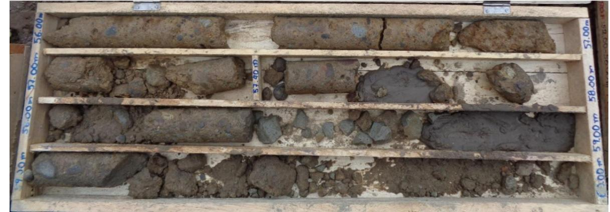
Figura 23. Tobas brechosas rojizas, en contacto con la secuencia sedimentaria. Portal de salida del túnel Bobmolí. Sondeo PTB-4. Tramo 56.00-60.00m (758632E;9950473N).
