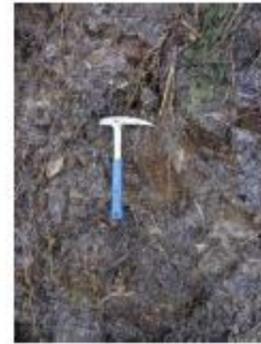
RPS- 2. Afloramiento compuesto por roca volcánica, Andesitas de composición Acida de textura porfirítica.
