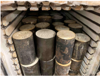
Fig. 49: Los cilindros dentro del horno de quemado.
