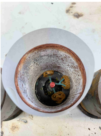
Fig. 48: Árbol de colada dentro de su respectivo cilindro.
