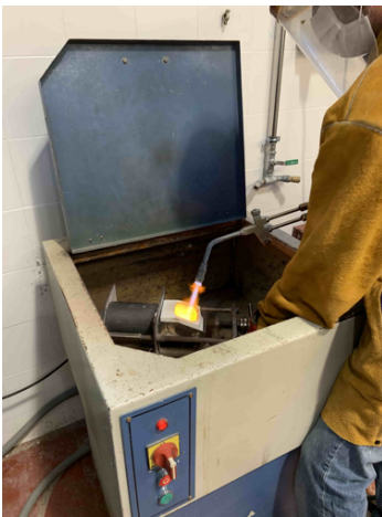
Fig. 50: Fundición del metal en la centrifugadora.
