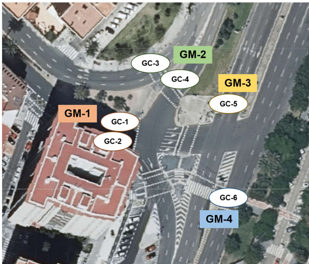
Ilustración 17. Grupo de movimientos y grupo de carriles de la intersección semafORIZADA. Fuente: Elaboración propia.
