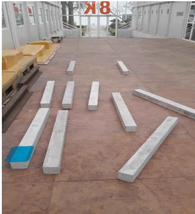
Figura 4.4. Vigas correspondientes a las diferentes dosificaciones. Fuente: elaboración propia
