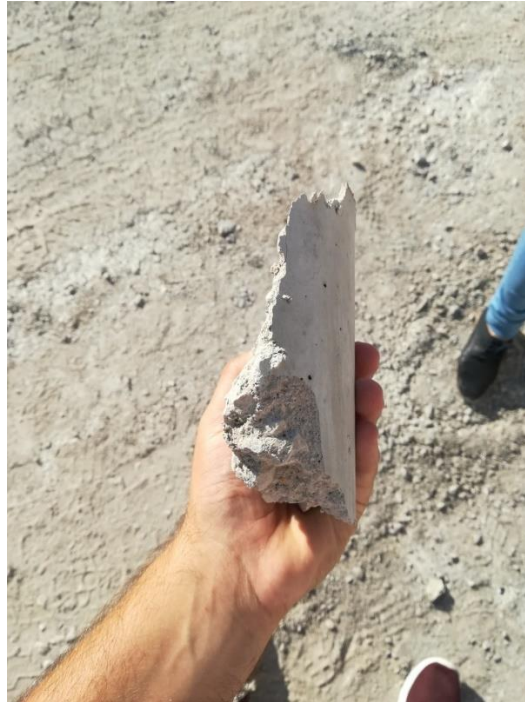
Figura 4.21. Plano de rotura provocado durante ensayo de resistencia a compresión. Fuente: Elaboración propia
