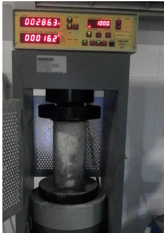
Figura 4.20. Ejecución ensayo de resistencia a compresión. Fuente: Elaboración propia
