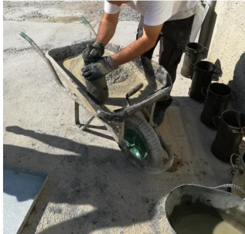
Figura 4.17. Trabajos de relleno de probetas. Fuente: Elaboración propia
