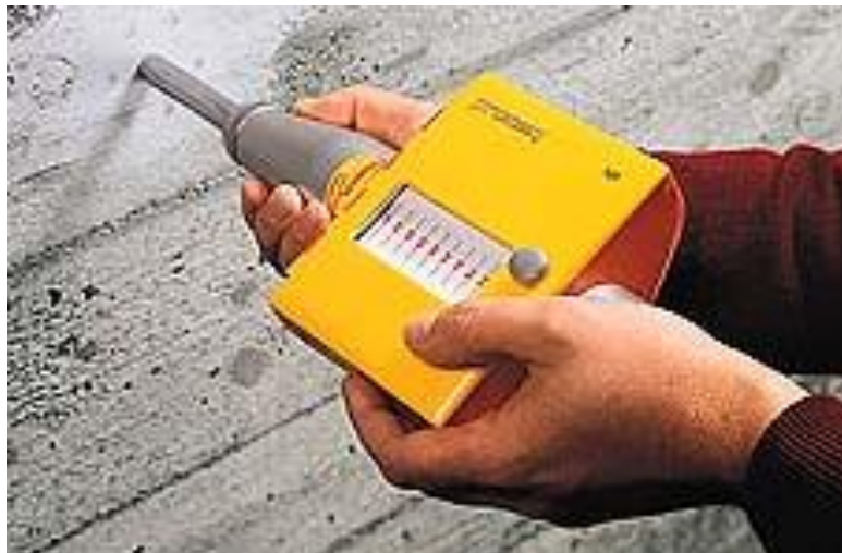
Figura 4.12. Esclerómetro, acompañado de medidor. Fuente: Proceq
