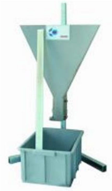
Figura 4.6. Herramientas empleadas en el ensayo de consistencia
