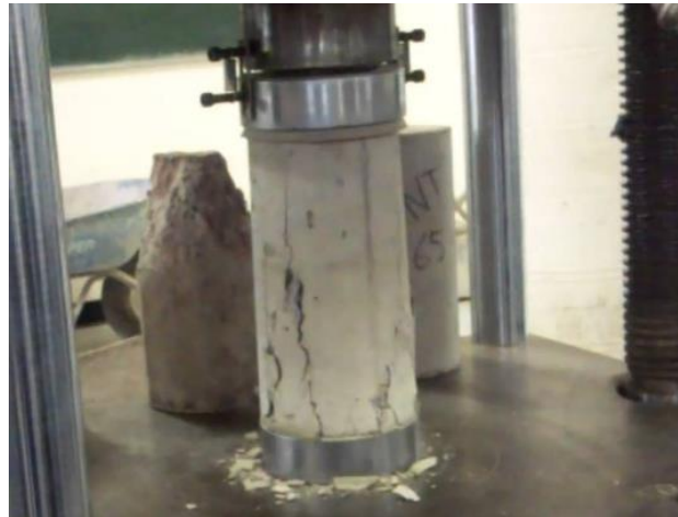
Figura 4.1. Ensayo de resistencia a compresión en prensa. Fuente: Prontubeam
