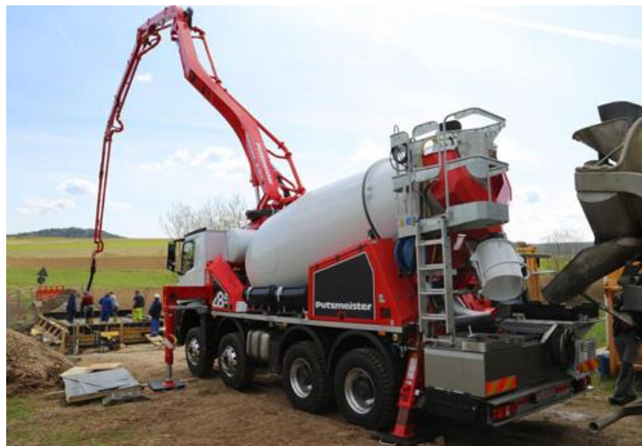
Figura 5.3. Camión bomba de hormigón. Fuente: [28]
