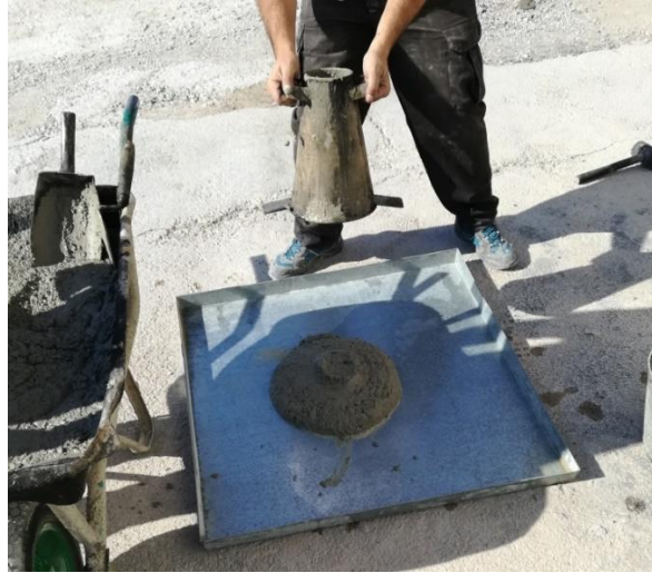
Figura 4.18. Ejecución cono de Abrams. Fuente: Elaboración propia
