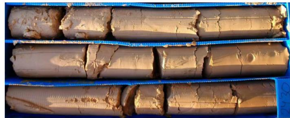
Ilustración 12. Muestra del nivel geotécnico 1, tramos de limos arenosos más uniformes.
