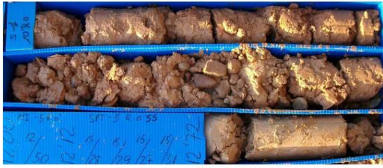
. Ilustración 19 Muestra del nivel geotécnico 1, zona de interacción de gravas arenosas.
