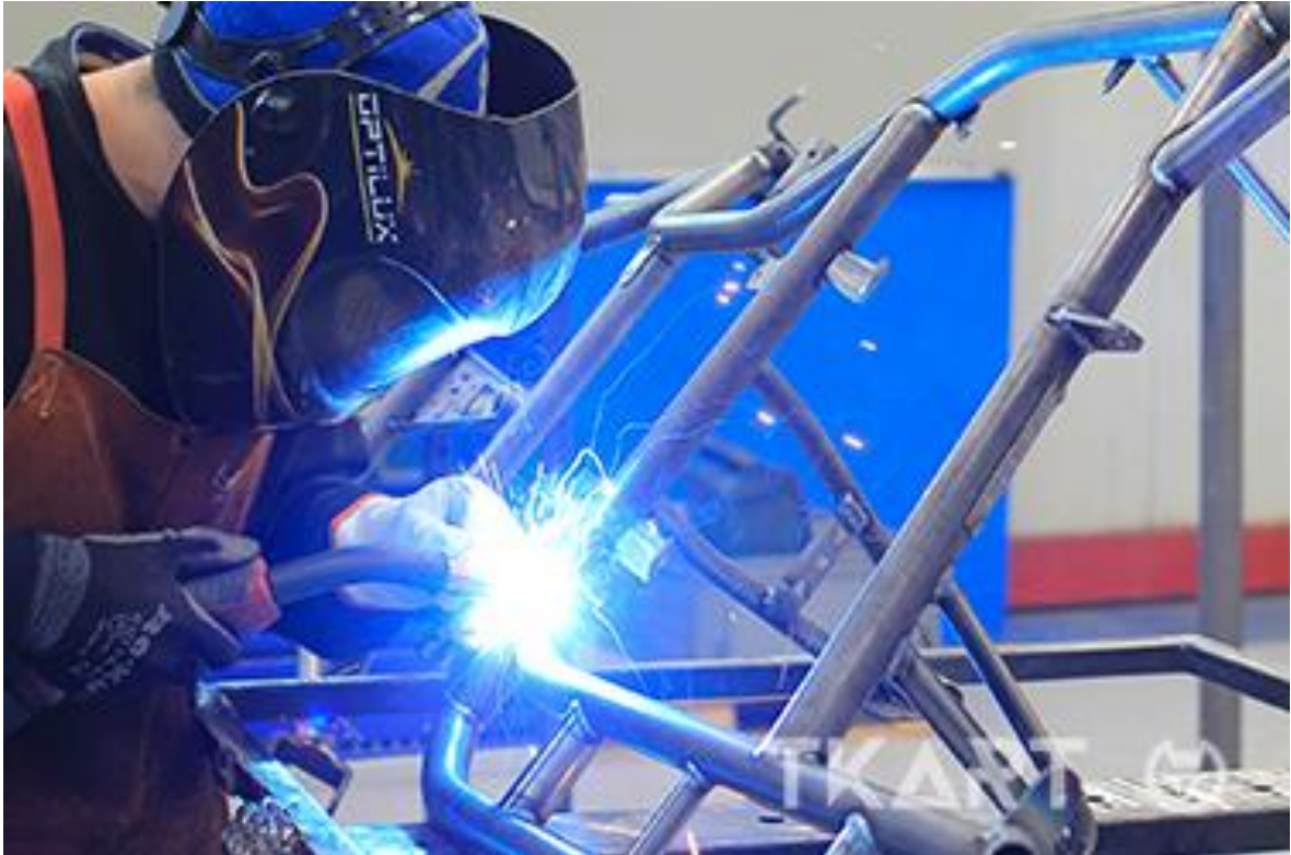
Il·lustració 94: Soldadura de un xassís de kart amb MIG
