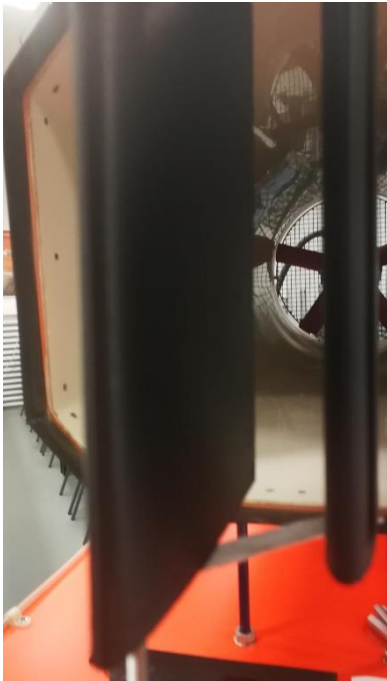
Ilustración 35: Configuración biplana en túnel de viento
