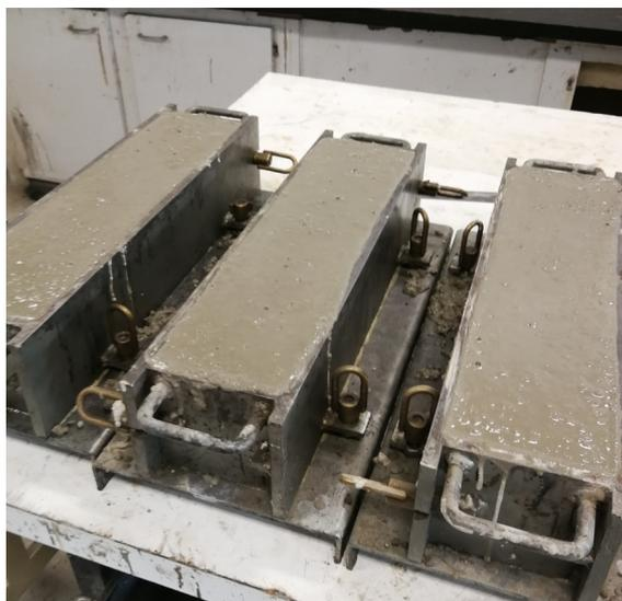
Imagen 30. Hormigón vertido en los moldes para las probetas 31A, 31B y 31C.
