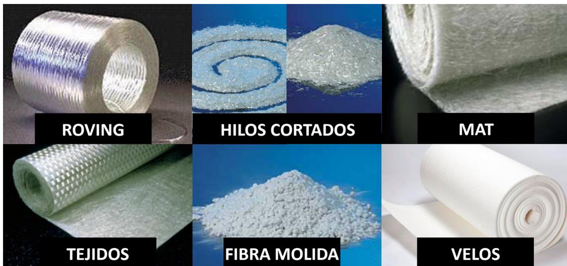
Imagen 8. Tipos de fibra de vidrio según su forma.<sup>[22]</sup>
