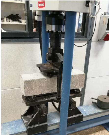
Imagen 40. Ensayo de flexión. Probeta en carga. (52A).
