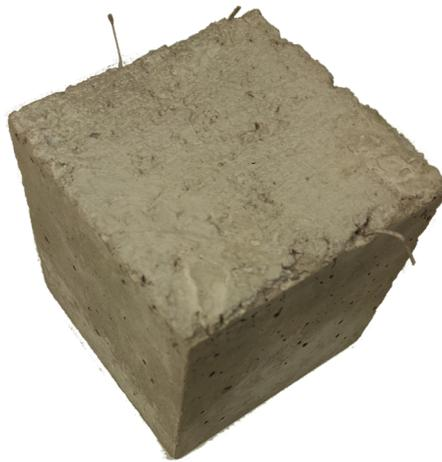
Imagen 9. Probeta de muestra del hormigón reforzado con fibra de poliolefina.
