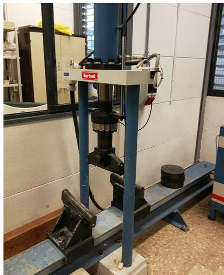
Imagen 34. Máquina para el ensayo de flexión. (2007).
