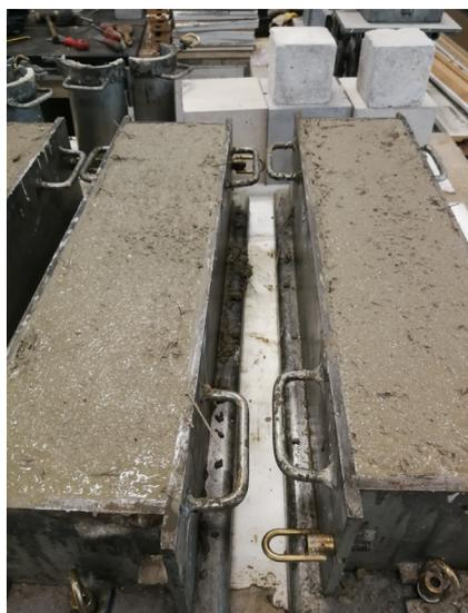
Imagen 33. Hormigón vertido en los moldes para las probetas 63A y 63B.
