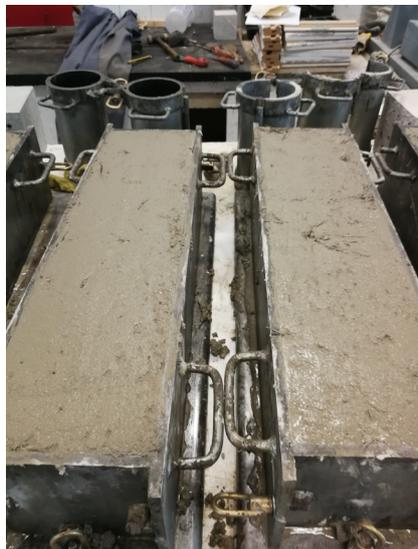
Imagen 32. Hormigón vertido en los moldes para las probetas 62A y 62B.
