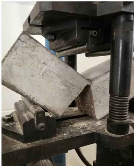
Imagen 39. Ensayo de flexión. Probeta en rotura. (41B).
