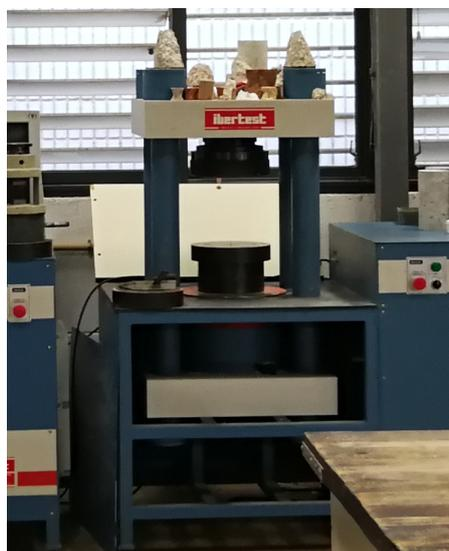
Imagen 35. Máquina para el ensayo de compresión. (1998).
