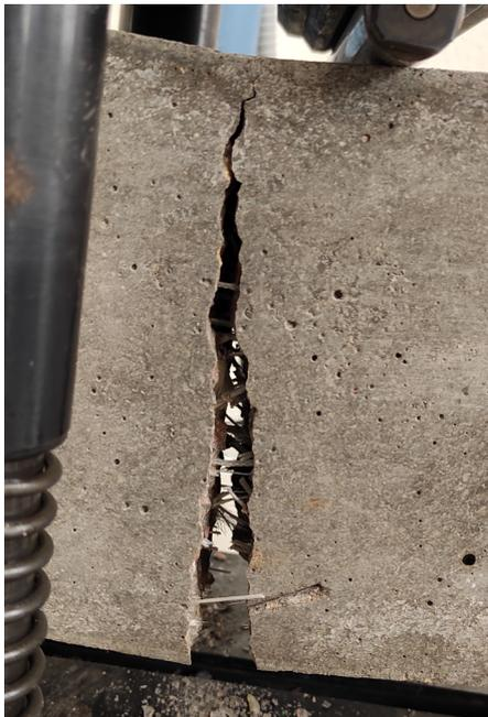
Imagen 45. Ensayo de flexión. Fisura. (81B).
