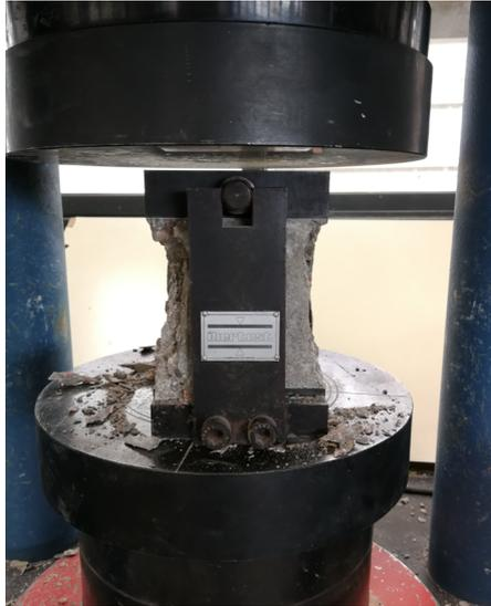
Imagen 48. Ensayo de compresión. Probeta en rotura. (11C, izq., vista de perfil)
