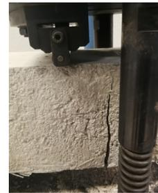
Imagen 65. Efecto de la fibra de poliolefina en la probeta 71A.
