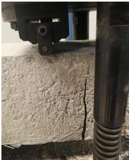
Imagen 43. Ensayo de flexión. Fisura. (72B).
