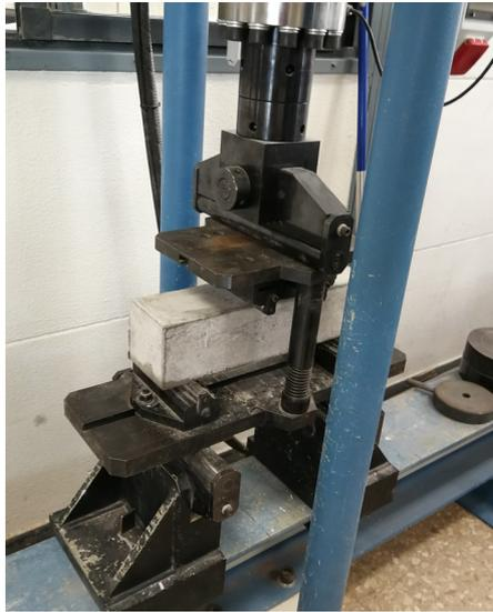
Imagen 38. Ensayo de flexión. Probeta en carga. (41B).
