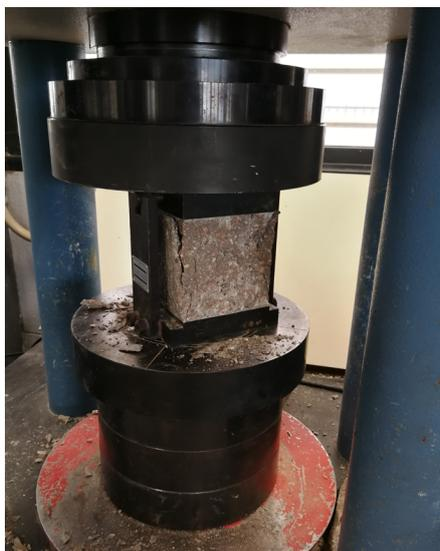
Imagen 47. Ensayo de compresión. Probeta en rotura. (11C, izq.)
