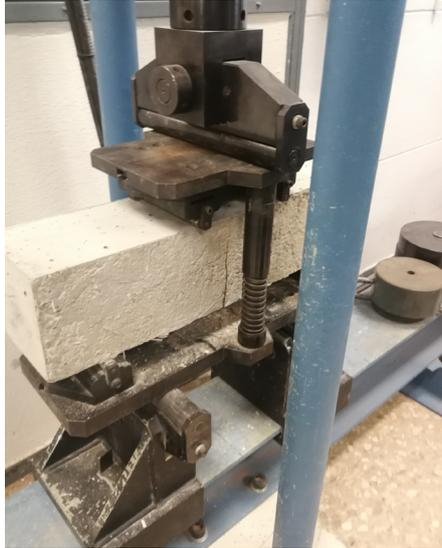
Imagen 42. Ensayo de flexión. Probeta en rotura. (72B).
