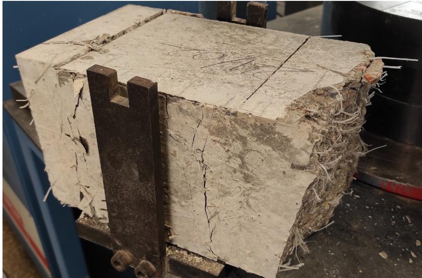
Imagen 52. Ensayo de compresión. Probeta en rotura. (81A, izq.)
