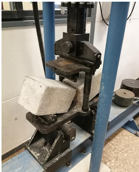
Imagen 41. Ensayo de flexión. Probeta en rotura. (52A).
