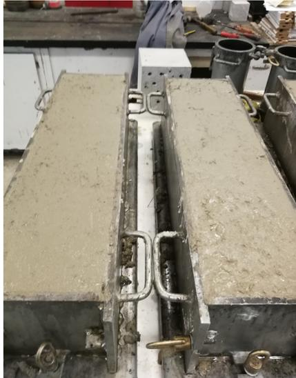
Imagen 31. Hormigón vertido en los moldes para las probetas 61A y 61B.
