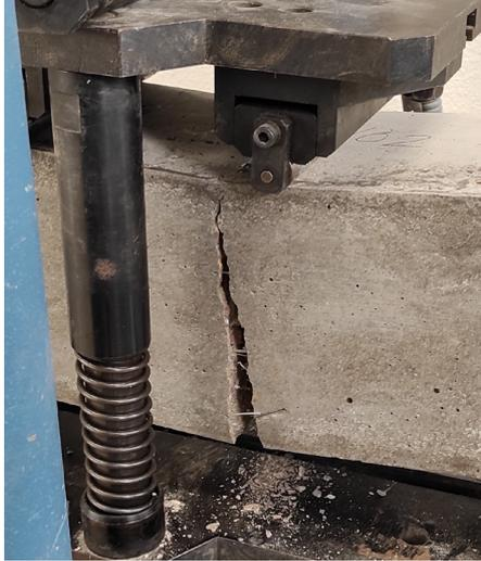
Imagen 44. Ensayo de flexión. Rotura. (81B).
