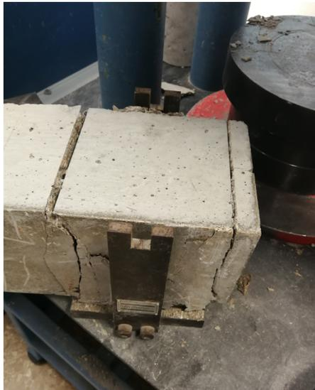
Imagen 49. Ensayo de compresión. Probeta en rotura. (51A, izq.)
