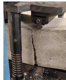
Imagen 67. Efecto de la fibra de poliolefina en la probeta 81A.
