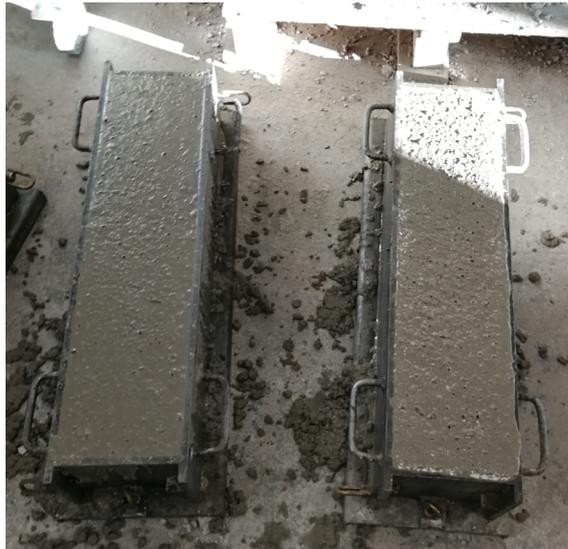
Imagen 29. Hormigón vertido en los moldes para las probetas del hormigón patrón 1 (11A, 11B).
