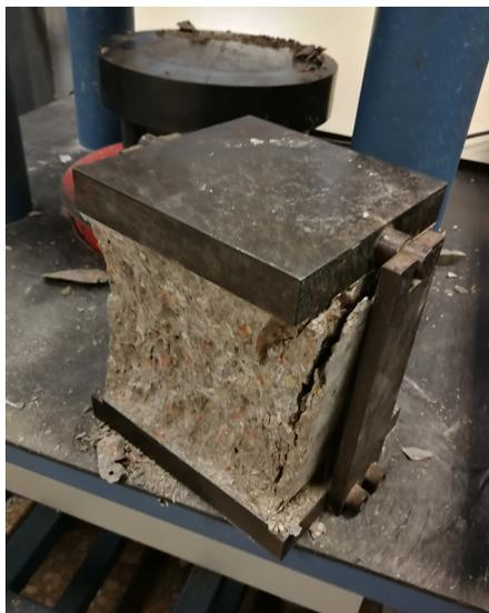
Imagen 46. Ensayo de compresión. Probeta en rotura. (11C, izq.)
