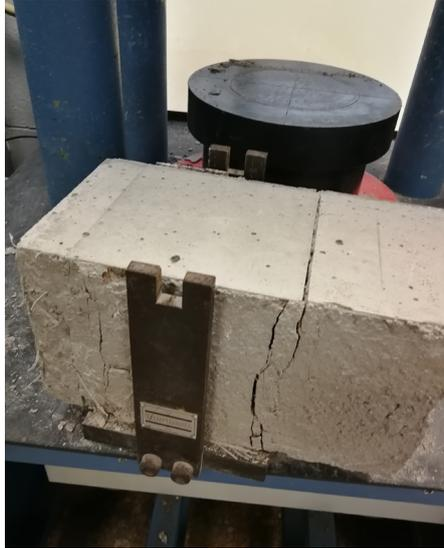
Imagen 51. Ensayo de compresión. Probeta en rotura. (71A, izq.)
