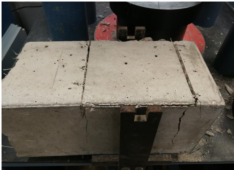
Imagen 50. Ensayo de compresión. Probeta en rotura. (61A, izq.)
