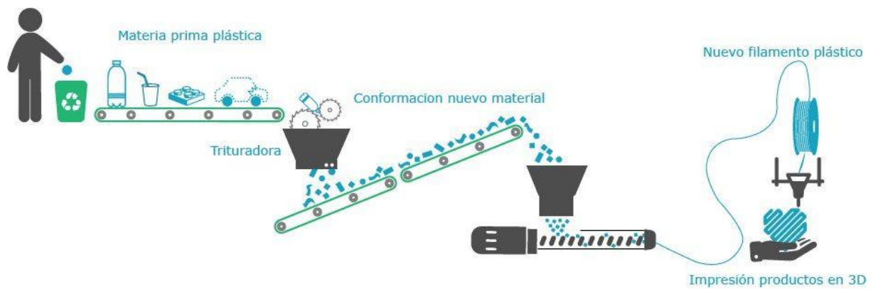
Figura 110. Proceso de reciclaje plástico para filamento. Fuente: Pinterest. (2021).
