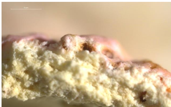
Fig. 107. Probeta B5 (X50) sección transversal post consolidación.
