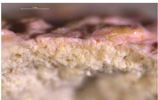
Fig. 131. Probeta I5 (X32) sección transversal post consolidación.
