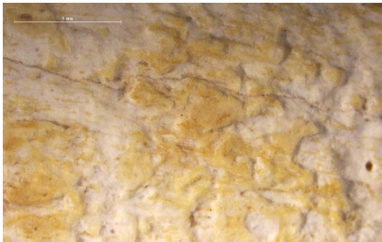
Fig. 81. Probeta A4 (X10) antes de la consolidación.
