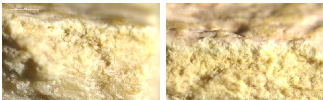
Fig. 175. Probeta A1 (X32) sección longitudinal post consolidación.
