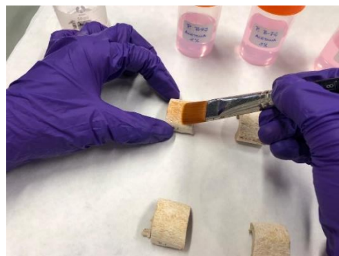
Fig. 30. Aplicación del consolidante mediante pincel.
