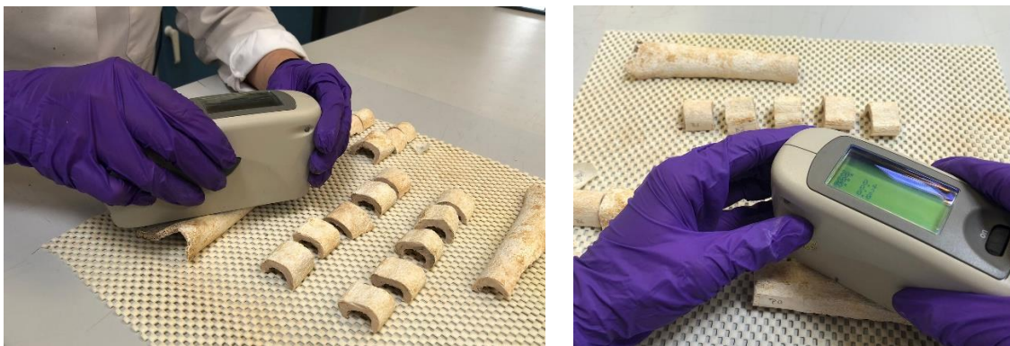
Figs. 141 y 142. Estudio fotométrico realizado con el medidor de brillo Multi Gloss 268 de KONICA MINOLTA®.
