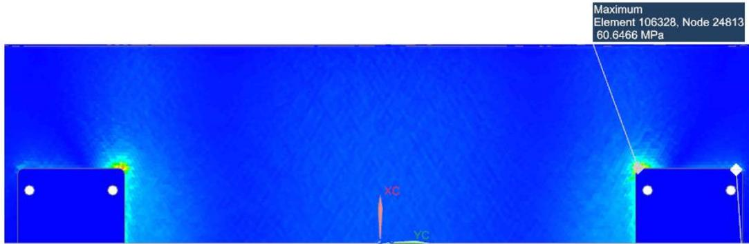
Imagen 87. Tensión máxima de la tabla sometida a un esfuerzo en su parte central
