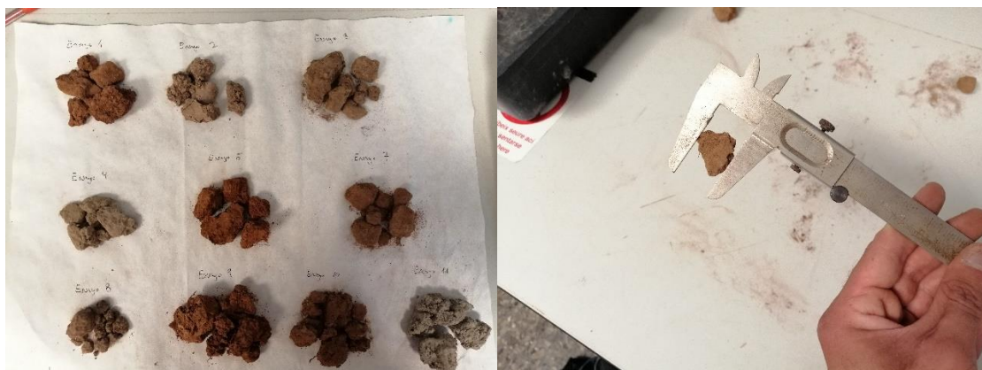
Figura 14: Metodología de medida del tamaño de los agregados
