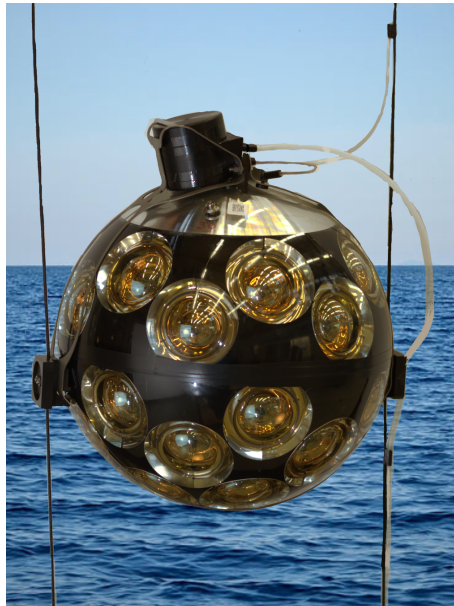
Figura 8: DOM integrado en la DU gracias a dos cuerdas paralelas de Dyneema y la estructura de titanio. Pegado a la cuerda de la derecha se observa el cable electroóptico, también conocido como backbone cable
