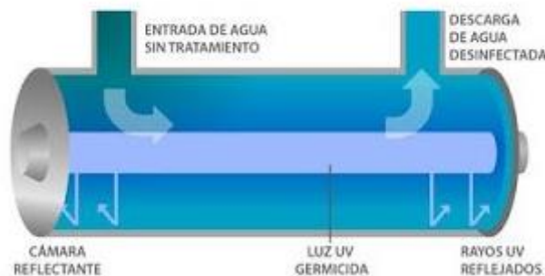
Figura 3. Esquema del tratamiento del agua mediante luz ultravioleta. (Hidroserver, 2013)
