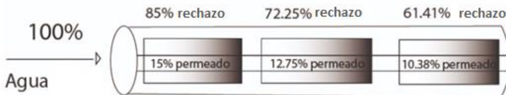
Figura 15. Ejemplo de membranas en serie dentro de un tubo de ósmosis inversa. (Culling Water Projects, 2017)
