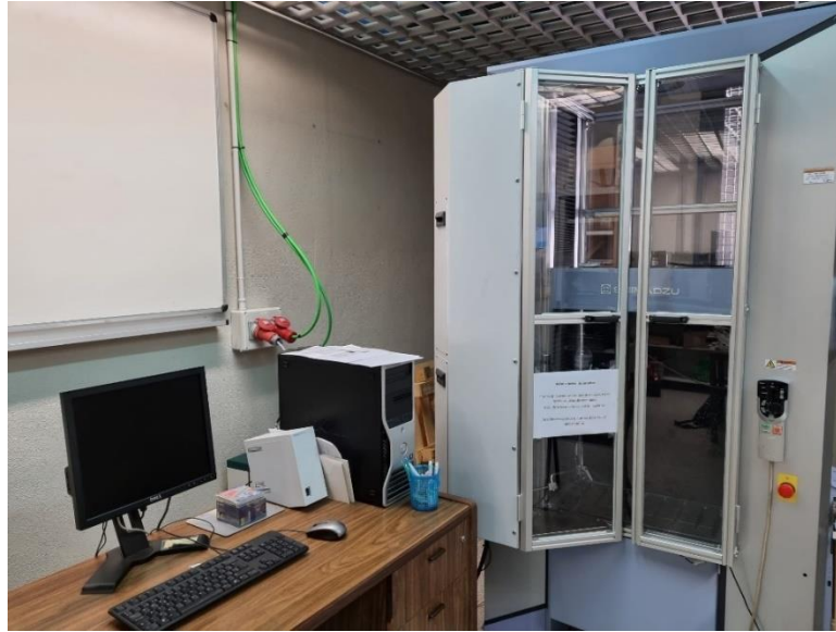
Figura 20. Máquina universal Shimadzu que se utiliza en ensayo de flexión a 4 puntos.
