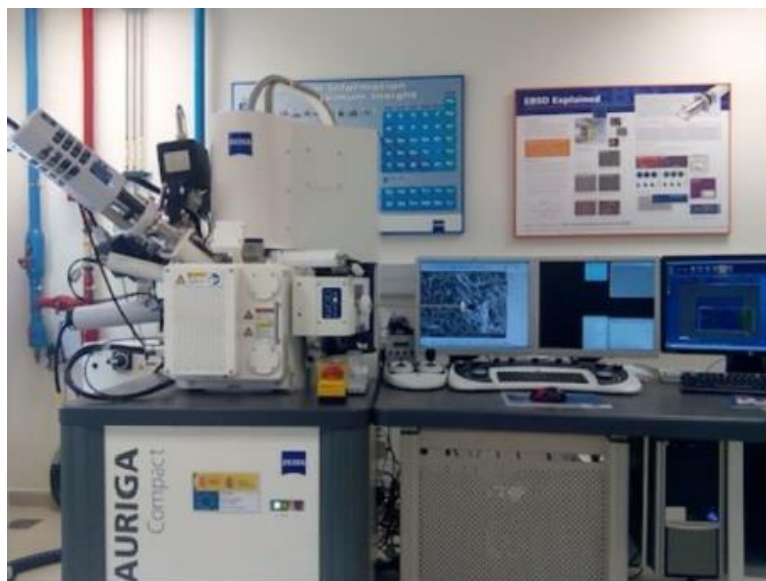
Figura 15. Microscopio electrónico de barrido de emisión de campo modelo AURIGA de Zeiss.
