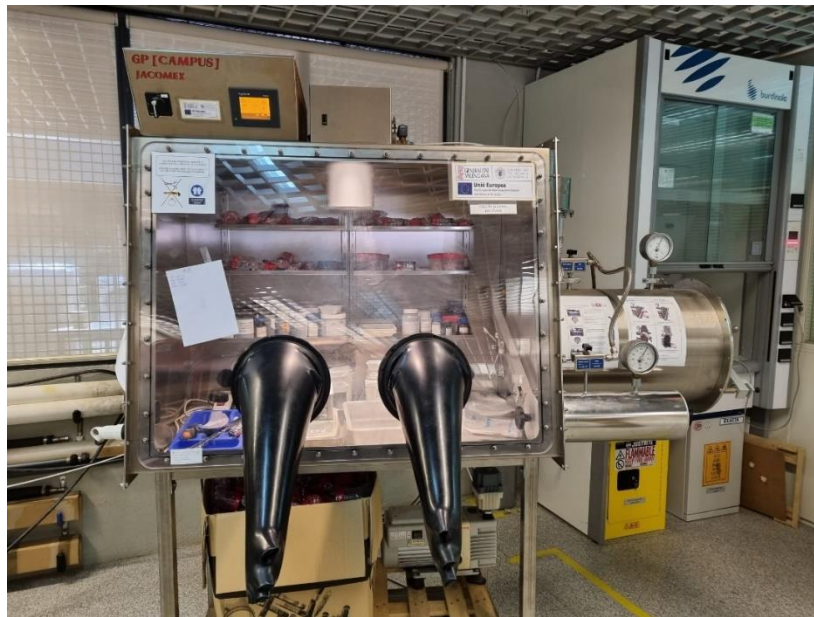
Figura 4. Cámara de guantes de laboratorio modelo GP Campus del fabricante Jacomex.
