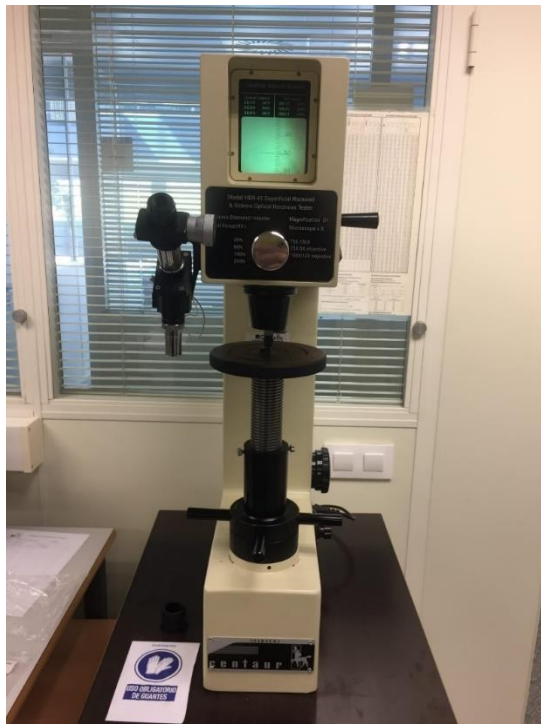
Figura 21. Durómetro universal HD9-45 de Centaur.
