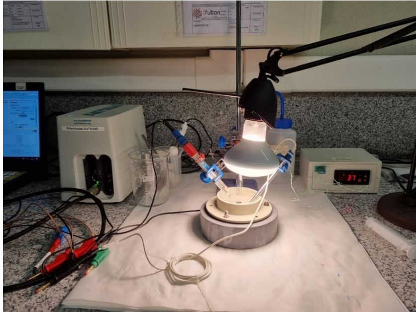
Figura 24. Montaje experimental del ensayo a corrosión.
