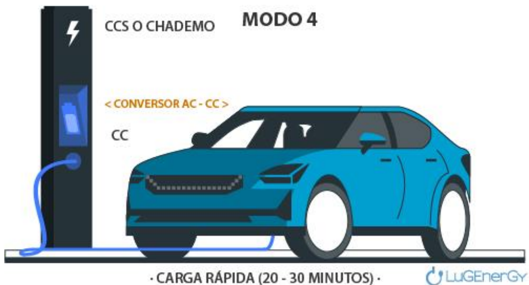
Ilustración 26: Ejemplo de modo de carga tipo 4. Fuente: Lugenergy.com
