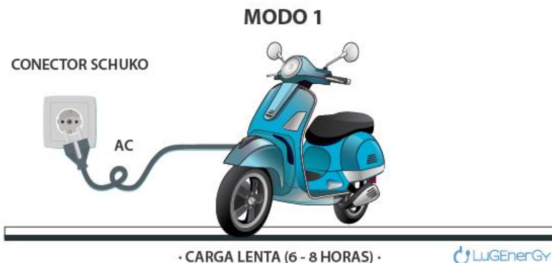
Ilustración 23: Ejemplo de modo de carga tipo 1. Fuente: Lugenenergy.com.
