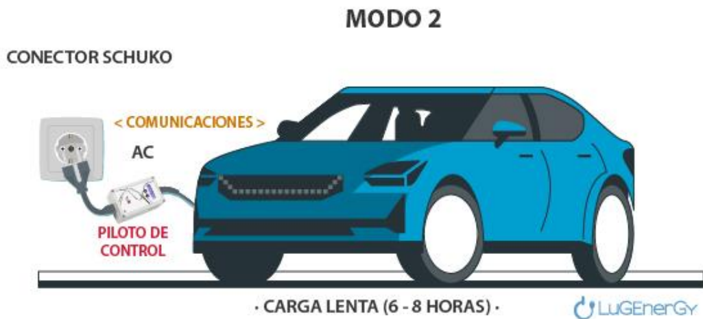
Ilustración 24: Ejemplo de modo de carga tipo 2. Fuente: Lugenenergy.com.
