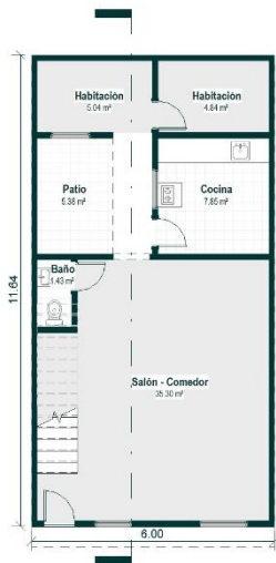
FIG. 2.2-36 Ejemplo de vivienda unifamiliar con la misma distribución espacial en ambos niveles, un único acceso directo a una escalera a modo de pasillo, sin continuidad en planta segunda, ya que en esta se desplaza junto al patio interior que mantiene su abertura en la terraza en donde se ubica el lavadero. Elaboración propia a partir de (Tarchópulosa Sierra & Ceballos Ramos, 2003; Torres Tovar, 2009).
