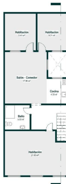
FIG. 2.2-37 Vivienda unifamiliar de dos niveles con local comercial y pequeño apartamento en planta baja, donde el acceso es compartido para ambos niveles. Elaboración propia a partir de (Tarchópulosa Sierra & Ceballos Ramos, 2003; Torres Tovar, 2009).
