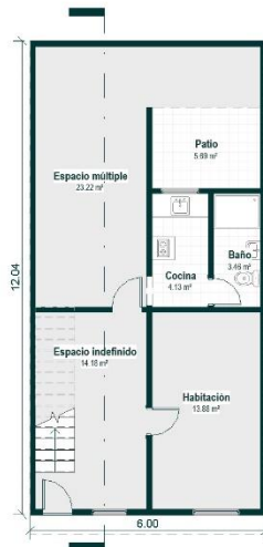
FIG. 2.2-44 Vivienda unifamiliar de dos niveles con viviendas independientes y patio interior que conserva el acceso a iluminación y ventilación por medio de la cubierta inclinada. Elaboración propia a partir de (Tarchópulosa Sierra & Ceballos Ramos, 2003; Torres Tovar, 2009).
