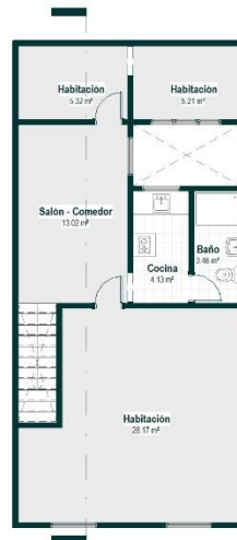
FIG. 2.2-44 Vivienda unifamiliar de dos niveles con viviendas independientes y patio interior que conserva el acceso a iluminación y ventilación por medio de la cubierta inclinada. Elaboración propia a partir de (Tarchópulosa Sierra & Ceballos Ramos, 2003; Torres Tovar, 2009).
