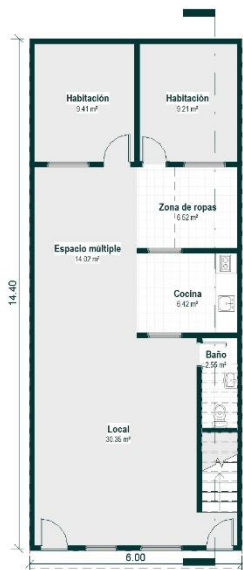
FIG. 2.2-37 Vivienda unifamiliar de dos niveles con local comercial y pequeño apartamento en planta baja, donde el acceso es compartido para ambos niveles. Elaboración propia a partir de (Tarchópulosa Sierra & Ceballos Ramos, 2003; Torres Tovar, 2009).
