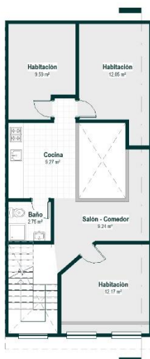
FIG. 2.2-43 Ejemplo de vivienda plurifamiliar con espacio de productividad en la planta baja, por lo que las escaleras se aíslan. En planta primera se identifica un vacío que no funciona como patio, pero si mantiene una relación entre áreas sociales. Elaboración propia a partir de (Tarchópulos Sierra & Ceballos Ramos, 2003; Torres Tovar, 2009).
