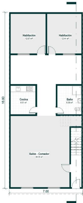
FIG. 2.2-38 Vivienda unifamiliar de dos a cuatro niveles con acceso compartido y terraza a modo de cubierta. Elaboración propia a partir de (Tarchópulos Sierra & Ceballos Ramos, 2003; Torres Tovar, 2009).
