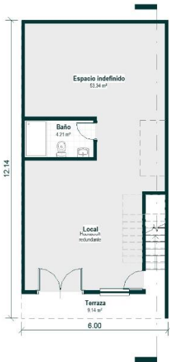
FIG. 2.2-35 Ejemplo de vivienda unifamiliar con espacio productivo en planta baja, cuyo acceso es independiente al acceso de la vivienda, se observa un pequeño espacio vacío en el interior sin acceso a iluminación o ventilación natural, posiblemente atribuido a un espacio de aprovechamiento, además de la terraza que sustituye la cubierta inclinada. Elaboración propia a partir de (Tarchópulos Sierra & Ceballos Ramos, 2003; Torres Tovar, 2009).
