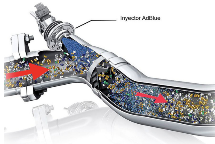
Figura 2.9: Inyección de urea en los gases de escape de un SCR
