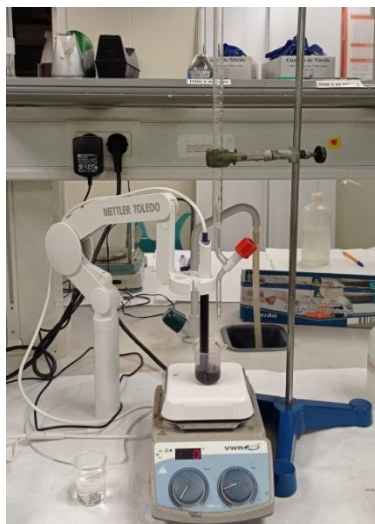
Figura 10. Proceso de medición de la acidez total con pH-metro
