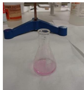
Figura 9. Coloración indicativa del final de la valoración
