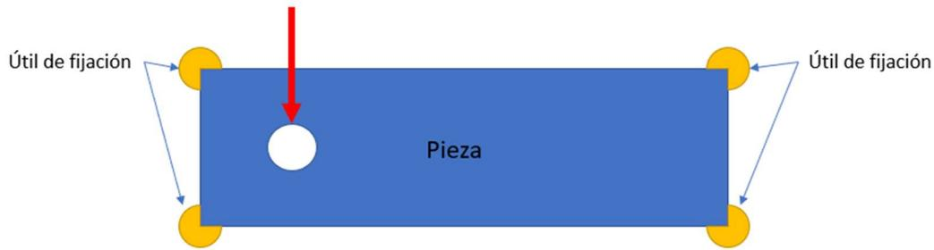
Un modo de fallo que puede darse sería la colocación de la pieza en la otra dirección, esto es, con el calado a la derecha. En caso de que fuera así se estaría soldando la tuerca en un lugar no funcional, por lo que la pieza debería ser desechada.
