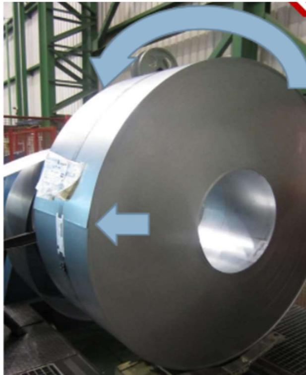
*Bobina de material con flechas indicando la dirección de alimentación y el sentido de giro*
