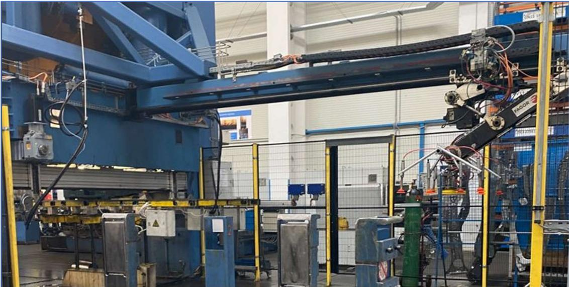
Fotografía del sistema de alimentación, donde se puede ver el robot manipulador y la guía. En la parte inferior se encontraría la pila de formatos.
