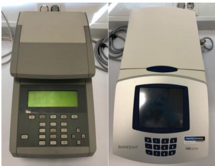
Figura 9. Termocicladores. A: 2720 Thermal Cycler (Applied Biosystems); B: Labcycler (SensoQuest)
