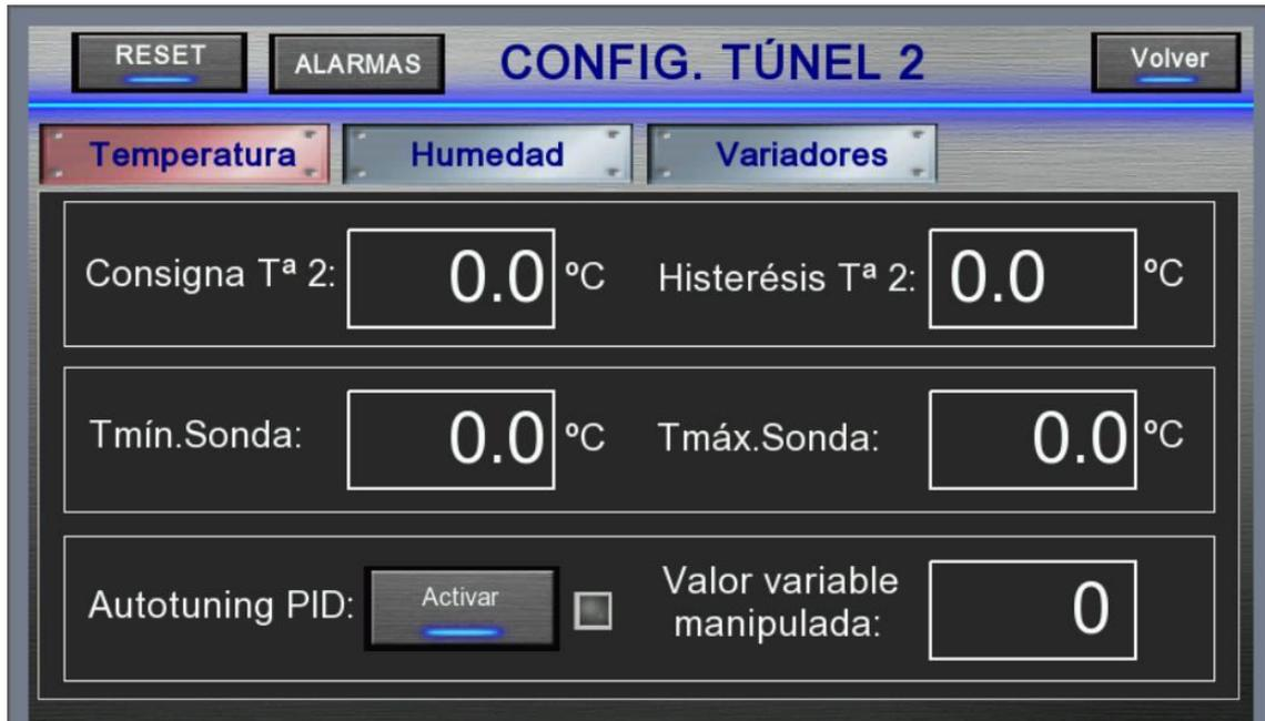
Figura 5.4.18 Configuración túnel 2 temperatura
