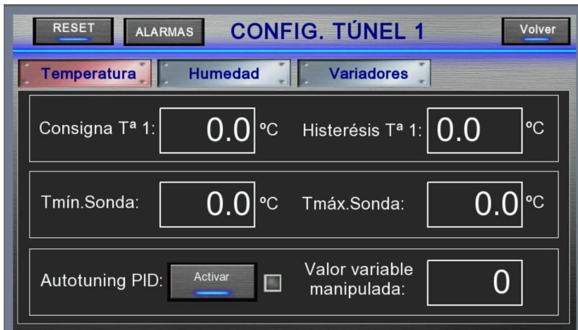
Figura 5.4.14 Configuración túnel 1 temperatura
