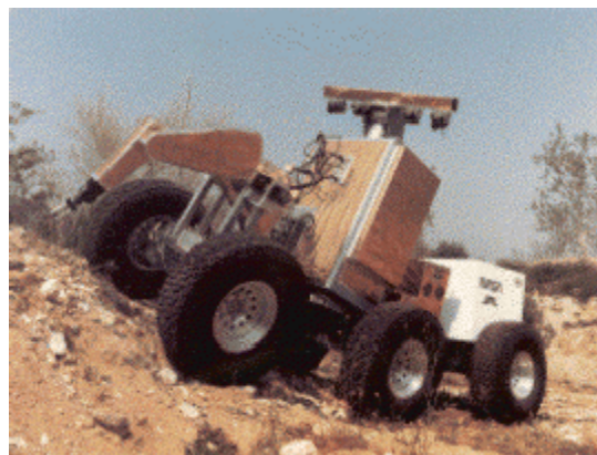
Figura 9: Robot rodante de 6 ruedas con independencia frontal y trasera
