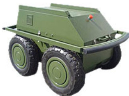
Figura 7: Robot rodante dotado de 4 ruedas en configuración 2+2
