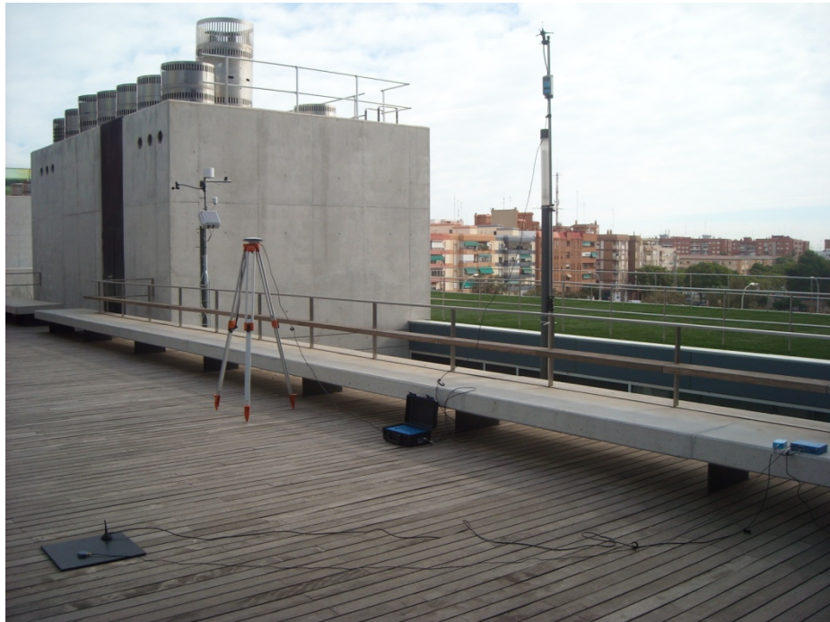
Figura 69: Área de pruebas con el VBOX 3i + DGPS montados
