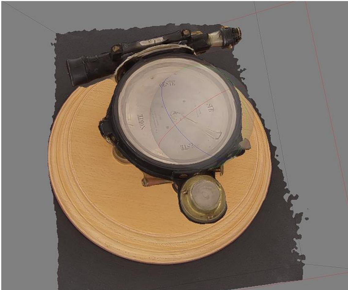
*Ilustración 80 Modelo 3D de la brújula taquimétrica. Aunque la consistencia del modelo es correcta, carece del detalle suficiente (ya que la resolución de la grabación es baja).*
