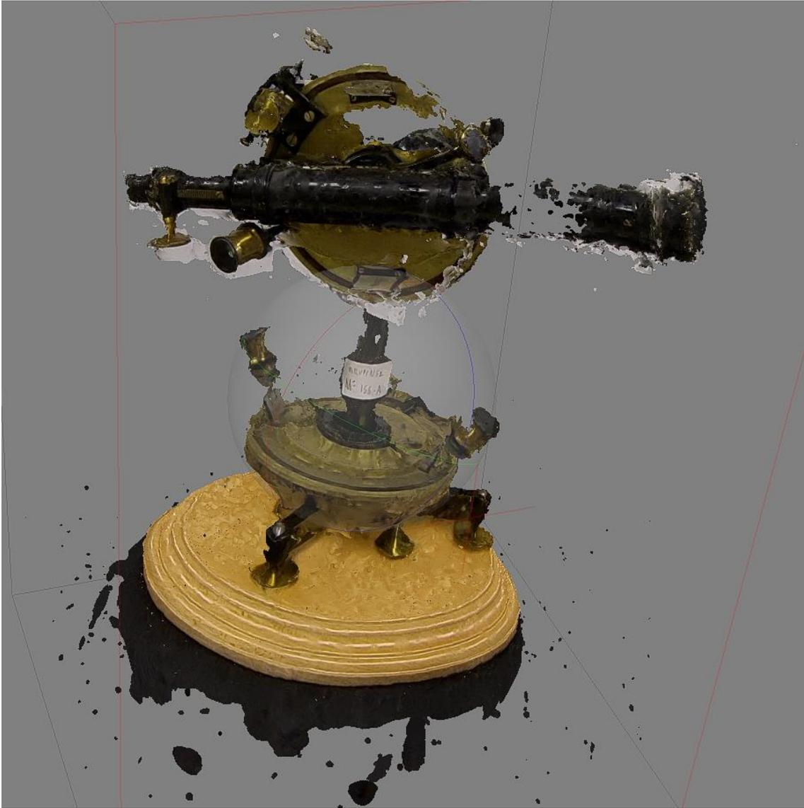
*Ilustración 78 Modelo 3D del teodolito generado a partir de la nube de puntos*
