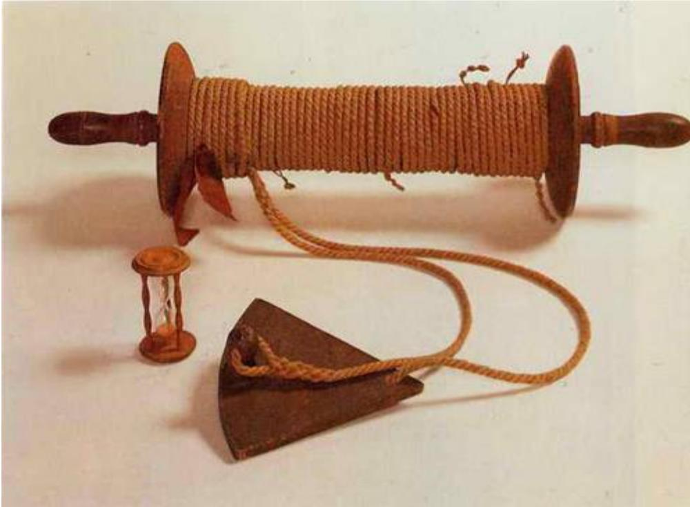
Ilustración 57 Corredera náutica. Fuente: <https://universomarino.com/2012/01/11/corredera-de-barquilla-sensor-de-velocidad/>
