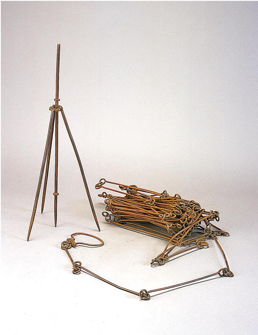
*Ilustración 54 Cadena de agrimensor. Este aparato disponía de un trípode que permitía clavar en el suelo un jalón que señalaba la estación para situar el instrumento goniométrico. Fuente: <https://www.ign.es/web/ign/portal/iccoleccion-instrumentos/>*
