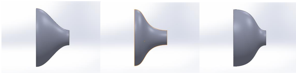
Il·lustració 19. Dissenys del con de contracció. D'esquerra a dreta: A, B, i C
