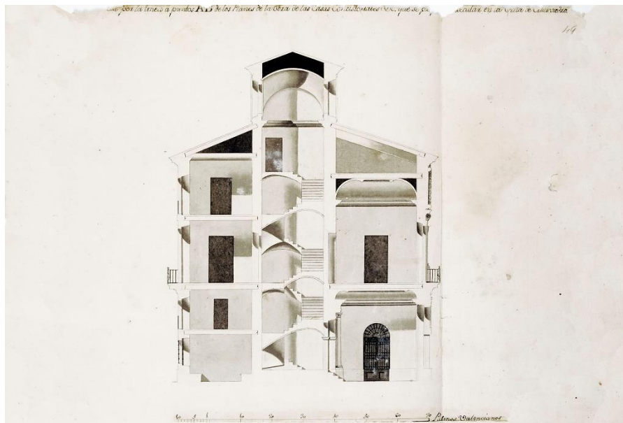
Plano de la sección de las Casas Consistoriales de Sagunto. (AHMV, Fondo V. Gascó: plano nº 49)
