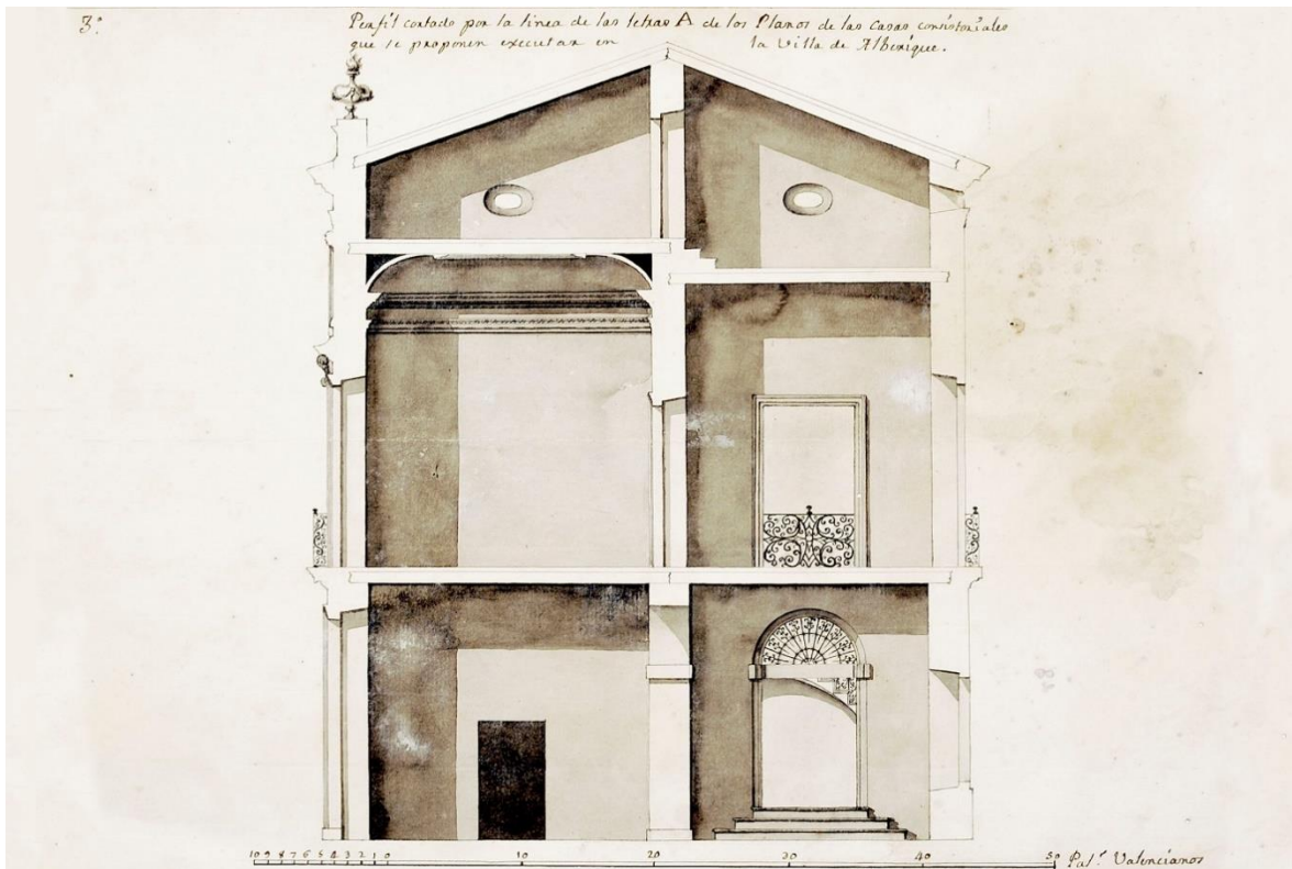
Plano en sección de las Casas Consistoriales de Alberique. (AHMV, Fondo V. Gascó: plano nº 3)
