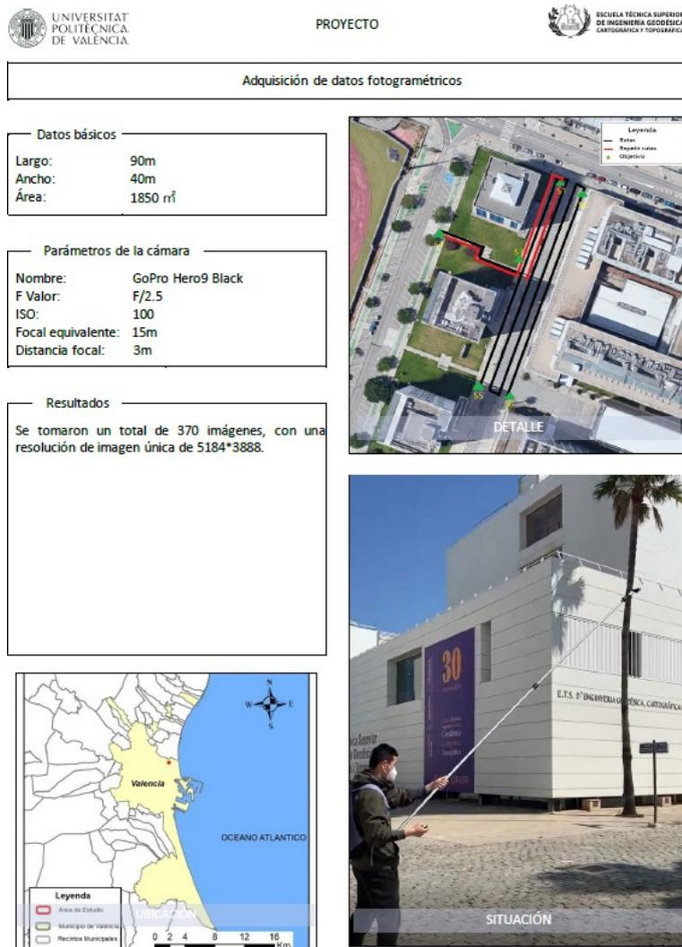
Figura 25 Adquisición de datos fotogramétricos
