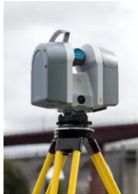
*Figura 4 Escáner láser 3D*
