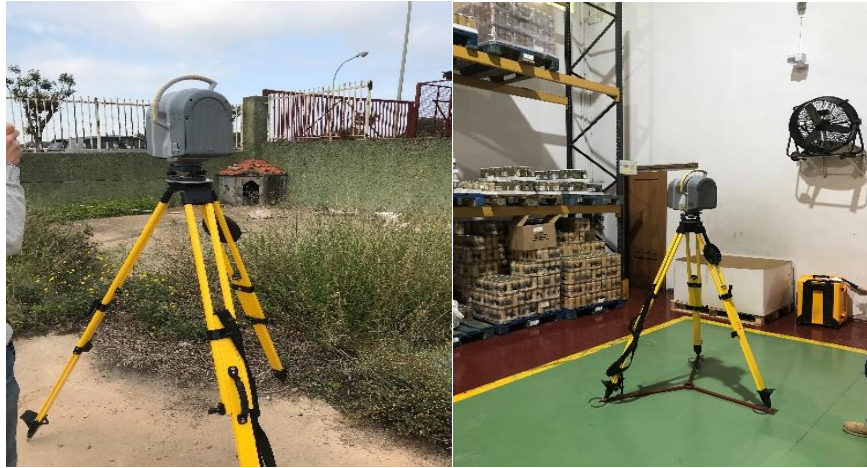
Figura 3: Fotografías del láser escáner Trimble TX6 realizando el levantamiento en campo.
