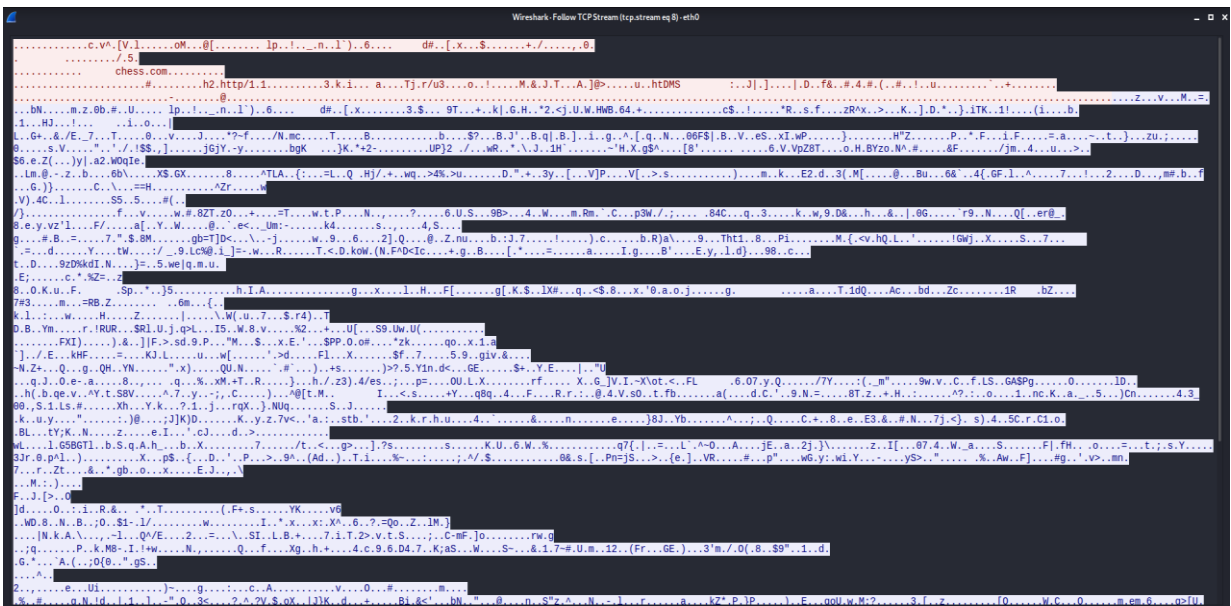
Figura 5.4.6: Captura de Wireshark de los datos encriptados
