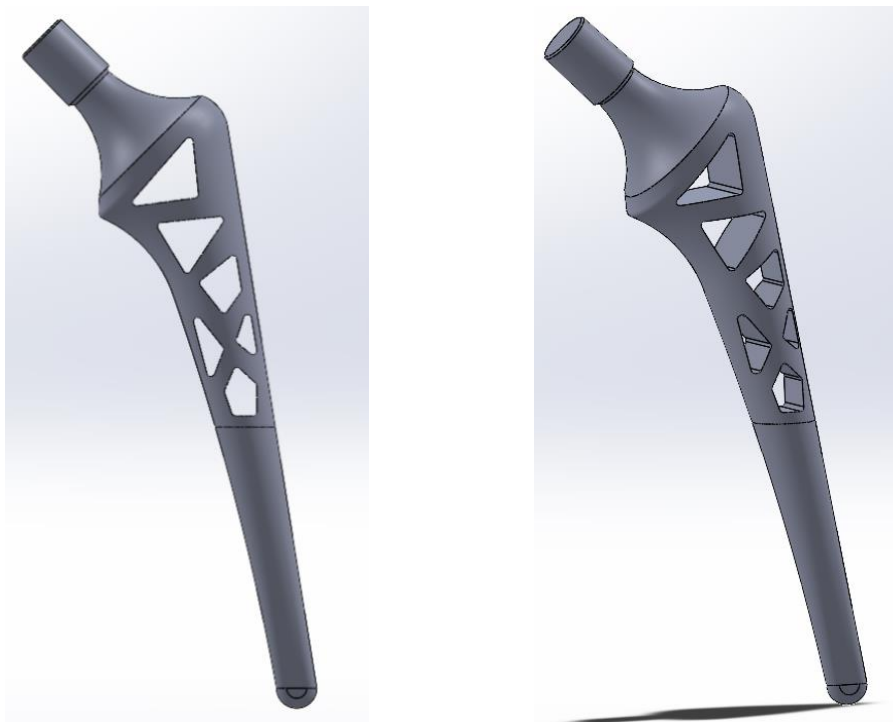
Figura 41. Vástago original optimizado
