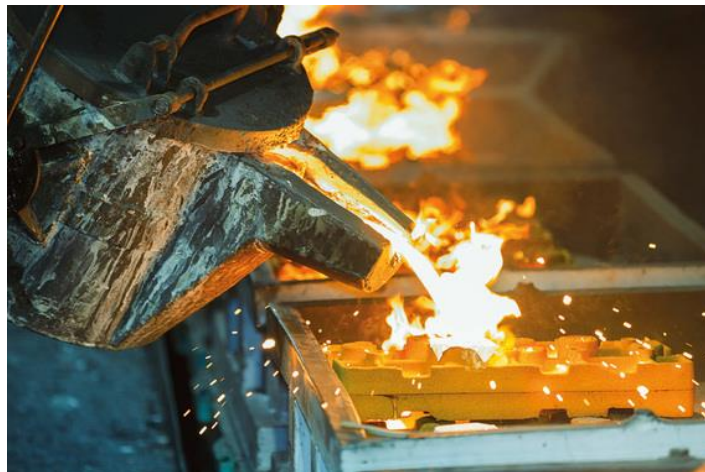
Figura 8. Fundición de hierro. Fuente [41]
