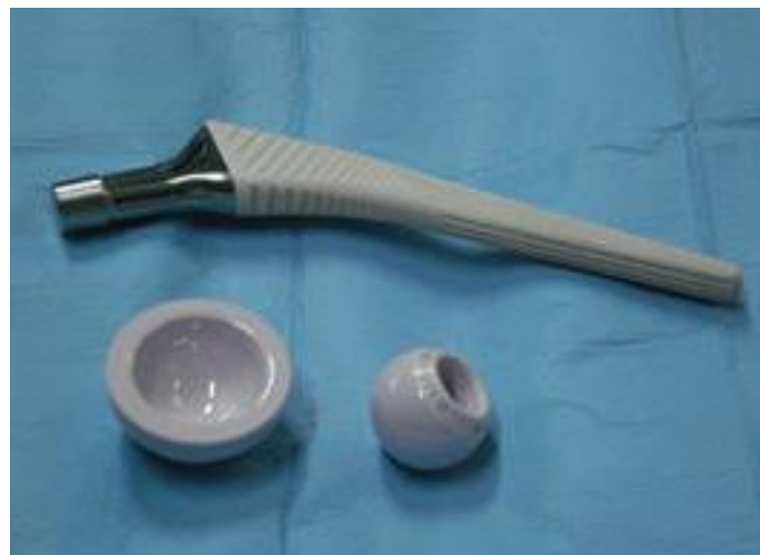
Figura 19. Ejemplo de prótesis de cadera con par cerámica-cerámica. Fuente [39]
