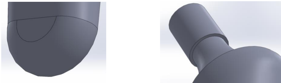
Figura 25. Detalle del redondeo distal (izda) y el cono morse (der)
