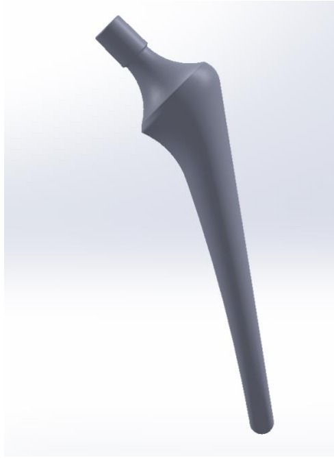
Figura 26. Vástago femoral diseñado con SolidWorks
