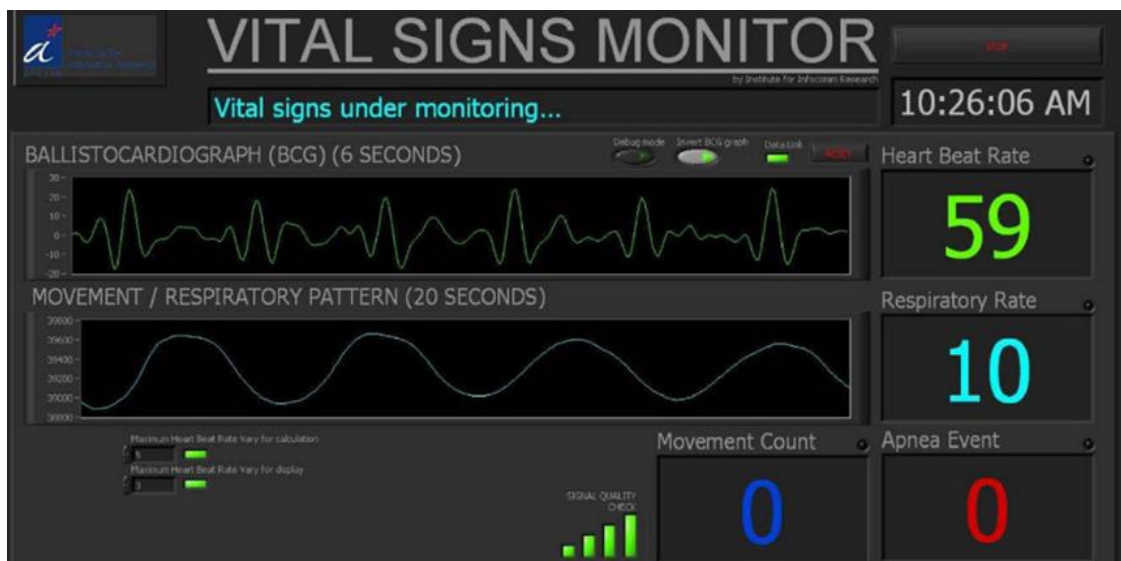
Figura 4. Interfaz gráfica de usuario para sensor de fibra óptica multimodo de microcurvatura.
