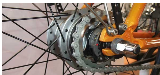
Figura 2 – cambio de marchas interno. Fuente: Biciplan
