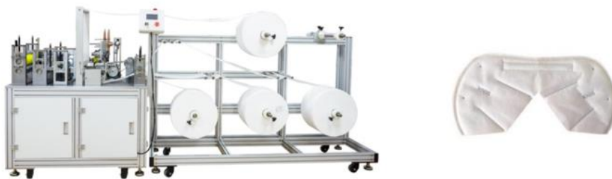
Ilustración 3. Máquina de formación de cuerpo de la mascarilla automática. (Fuente: www.testextextile.com )
