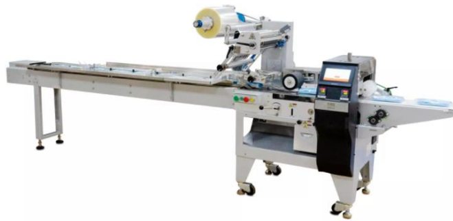
Ilustración 6. Empaquetadora automática de mascarillas APM10 (Fuente: www.testextextile.com )
