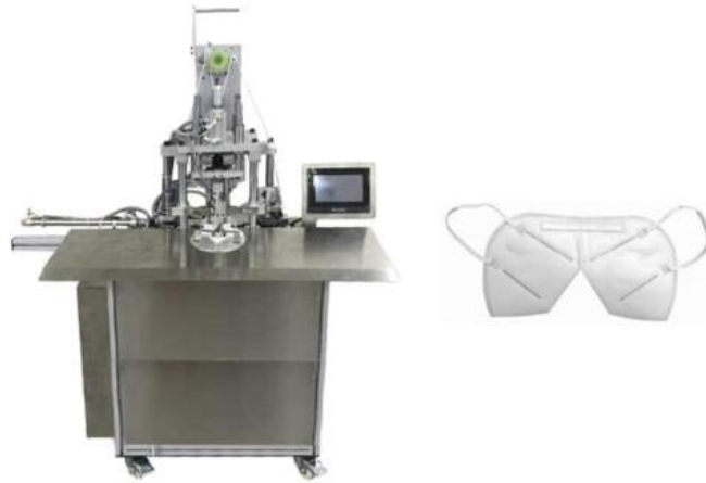
Ilustración 4. Máquina de soldadura ultrasónica Earloop (Fuente: www.testertextile.com )
