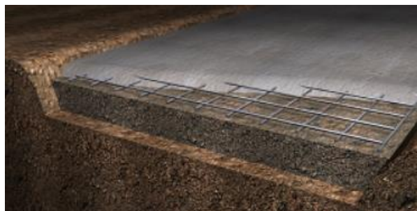
Ilustración 29. Solera (Fuente: Generador de precios, CYPE Ingenieros)
