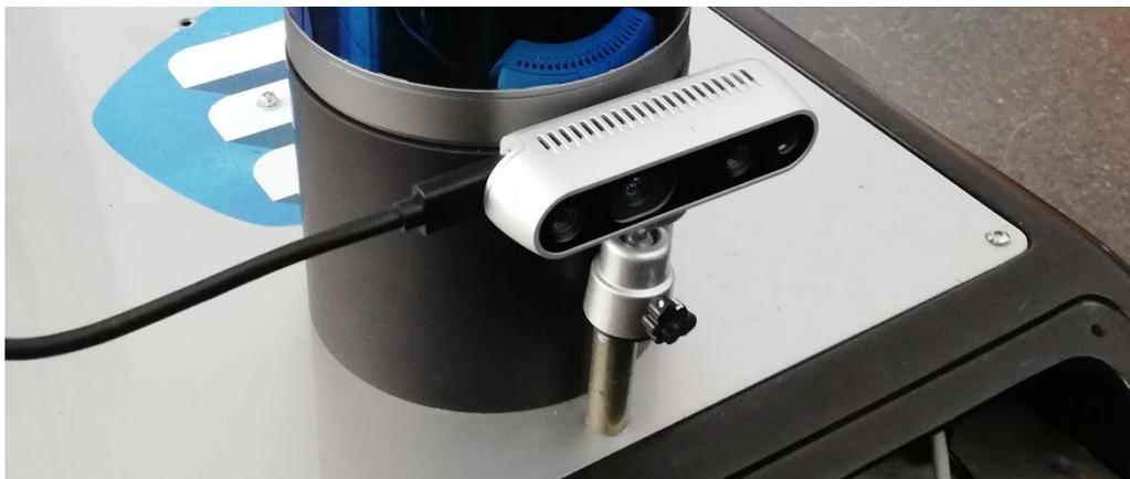
Fig. 17. Montaje de la Cámara Intel® RealSense™ D435 al SUMMIT-XL.
