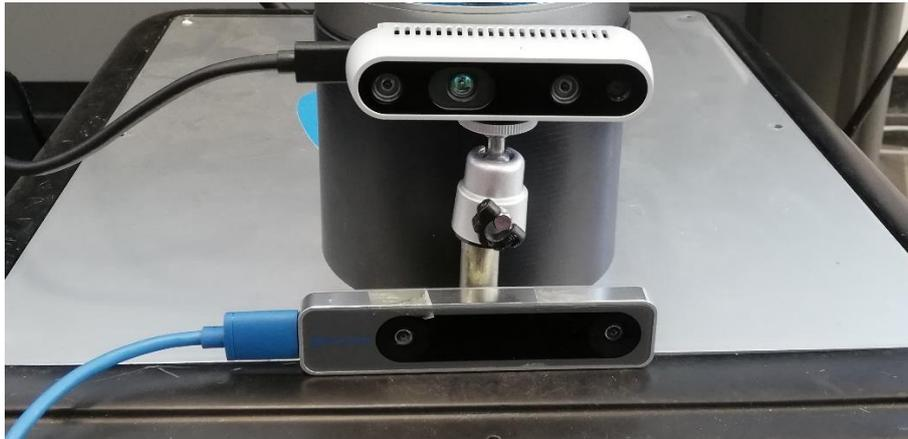
Fig. 23. Montaje de la Cámara Intel® RealSense™ T265 al SUMMIT-XL.
