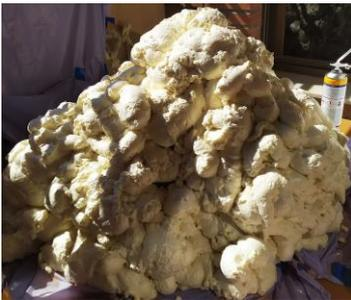
Figura 24. Espuma de poliuretano ya expandida
