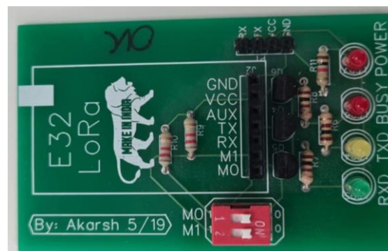
Figura 9. Imagen del circuito integrado auxiliar para el módulo E32.
