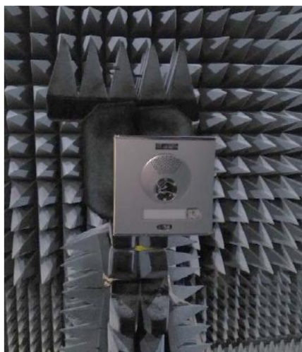
Figura 95. Medida de la antena con red de adaptación y con circuitería, con carcasa [38]
