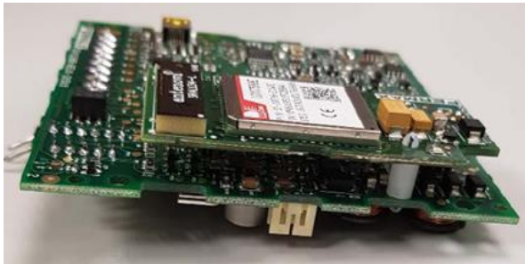
Figura 63. Medida de la antena con red de adaptación y con circuitería, sin carcasa [37]
