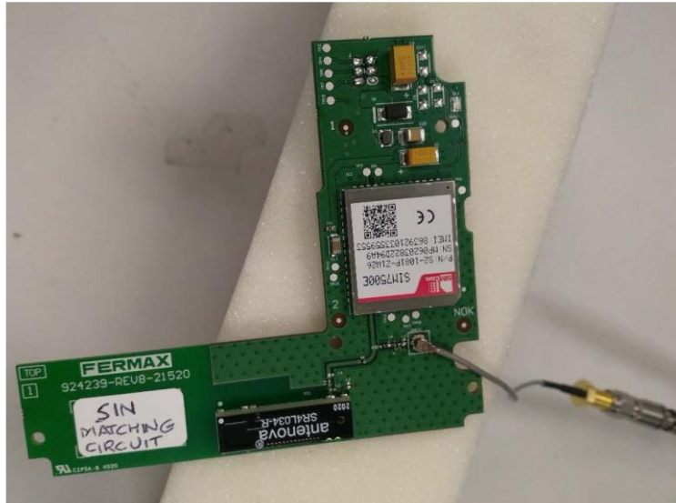
Figura 87. Producto Conectado con circuito en L para pruebas iTEAM [39]
