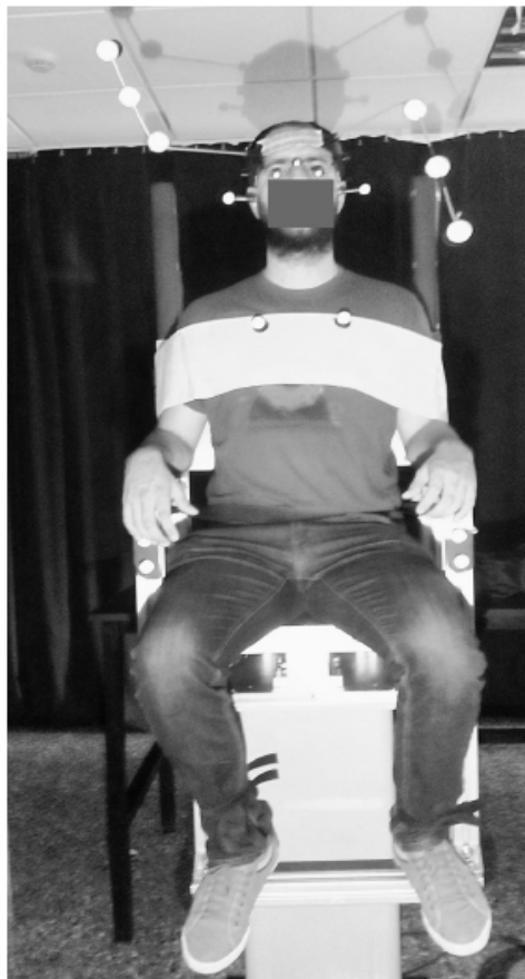
Figura 2.12: Validación de un modelo articular de cuello. El sujeto se sienta sobre una silla apoyada en una célula de carga de 6 ejes, de manera que sólo puede mover el cuello. El movimiento se registra mediante un sistema de video fotogrametría, mientras que la célula de carga registra las variaciones de fuerzas y momentos asociadas al cambio de posición de la cabeza y a las fuerzas de inercia. Esto permite comparar las fuerzas registradas por la célula de carga con las estimadas a partir del modelo biomecánico, lo que permite su validación. (Díaz- Rodríguez et al., 2016)
