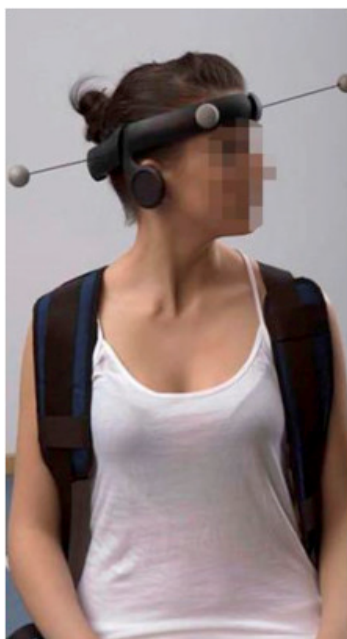
Figura 2.5: Sistema de marcadores para el análisis de movimientos de la cabeza con videofotogrametría (Sistema NedCerv-IBV)
