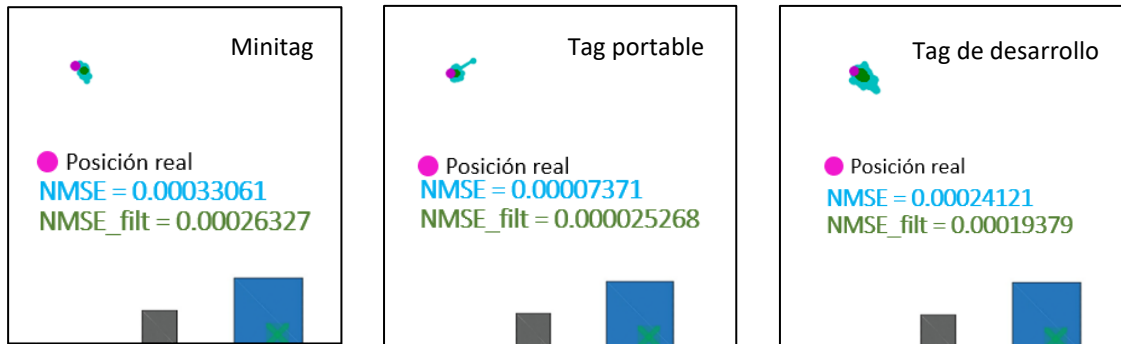
Ilustración 64 Datos de la posición filtrada y la posición obtenida por el sistema de Pozyx en el mapa (Pos. 2)
