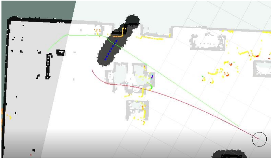
Ilustración 95 Ruta global inicial y replanificación de la ruta local del robot conocida una barrera
