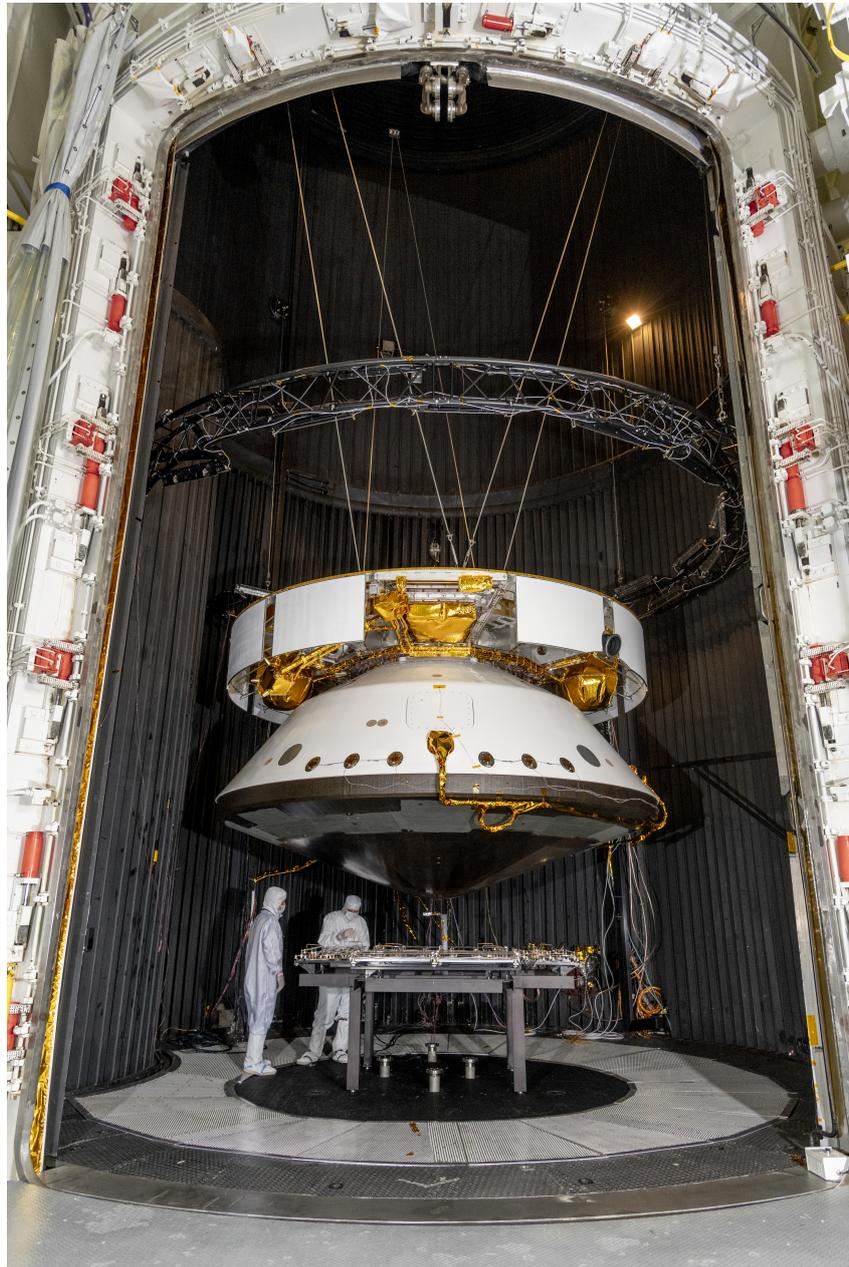
Figura 70: Mars2020 en la prueba de preparación para el vacío térmico [20]
