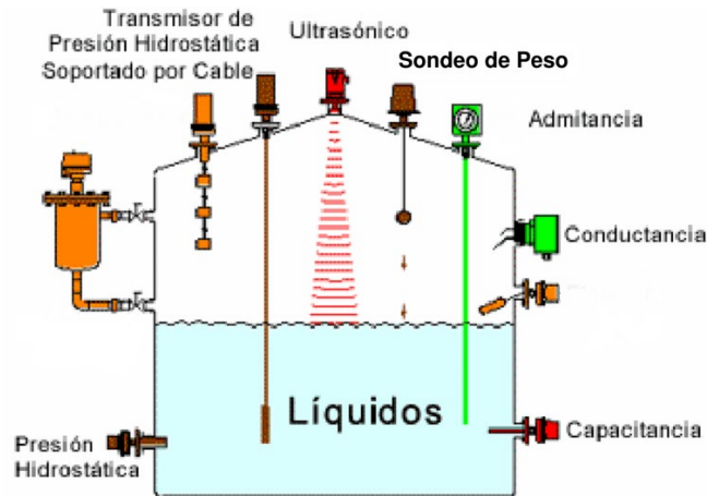
Figura 4. Tipos de medios para la realización de las mediciones en líquidos.
