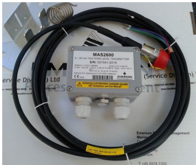
Figura 7: Cableado y componentes del del sensor de presión DAMCOS MAS2600 series.
