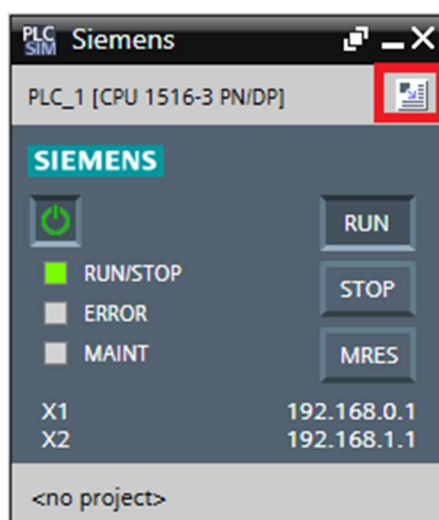
Figura 3.2 Pantalla principal del software PLCSIM de Siemens
