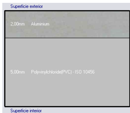
Imagen 11. Sección marcos ventanas
