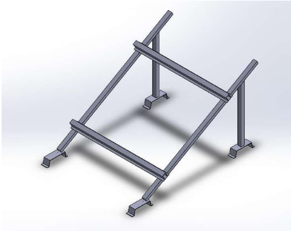
Imagen 2. Modelo 3D para estructura de 2 bastidores
