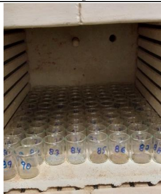
Figura 10: Determinación de materia orgánica (Calcinación).
