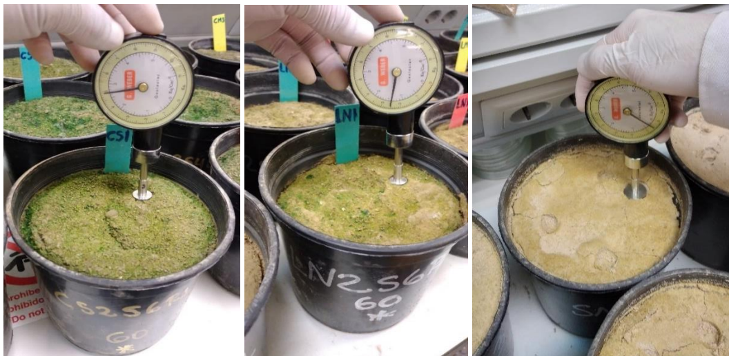
Figura 3: Medición de la resistencia a la penetración (60 días).
