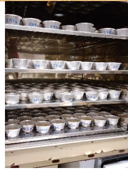
Figura 8: Determinación de estabilidad de agregados (Tamizado en húmedo).
