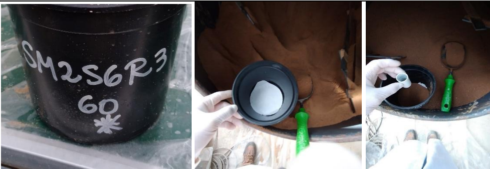
Figura 2: Codificado, Rellenado de macetas y colocación de tubos de PVC con suelos.
