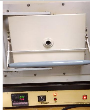
Figura 10: Determinación de materia orgánica (Calcinación).
