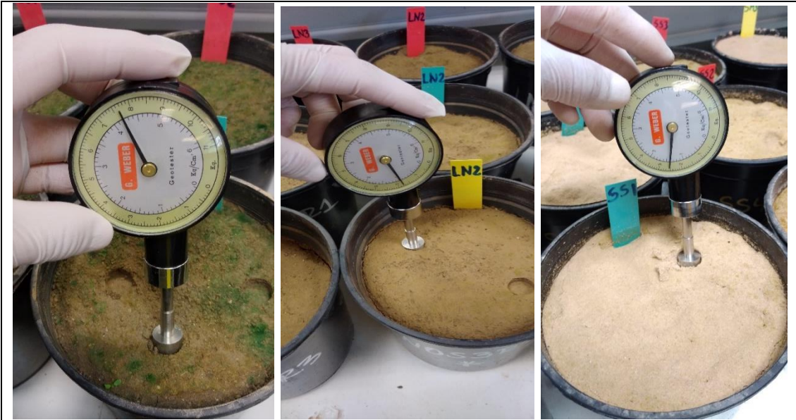
Figura 2: Medición de la resistencia a la penetración (30 días).
