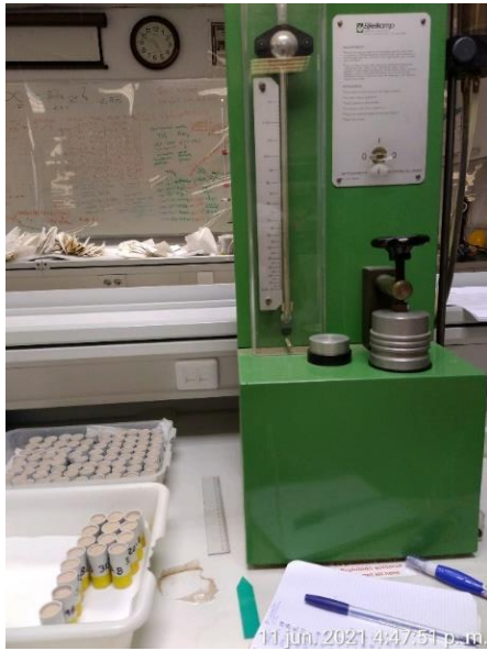
Figura 7: Determinación de porosidad (Picnómetro de laboratorio).
